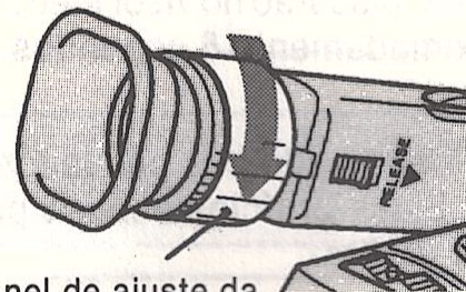
Anel de ajuste da objetiva do visor eletrônico
