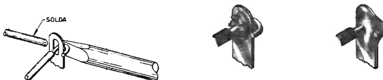
Figura 4 - Detalhes da ligação e soldagem a terminais
