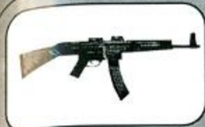
MP 44 (Calibre : 7.92 / Portée : 700m / Magasin : 35 cartouches / Poids : 4,3 kg) : Fusil d'assaut allemand conçu pour les parachutistes.
