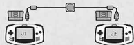
Game Boy Advance connectées avec le câble Game Boy Advance Game Link
