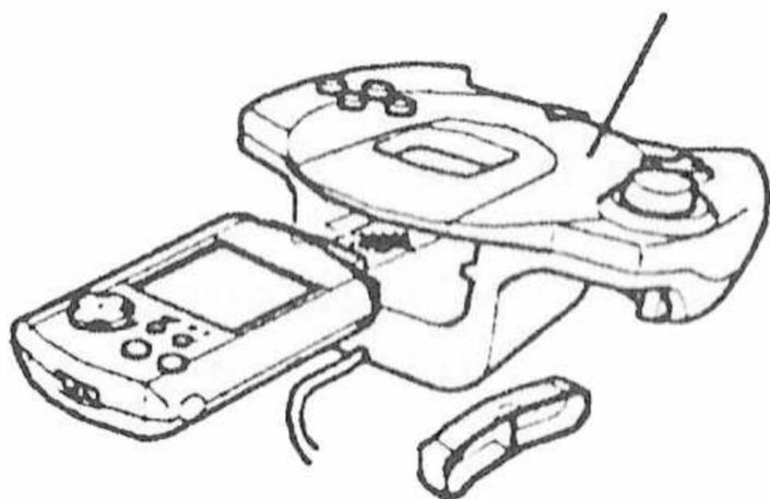
Remova a capa do VMU e então conecte-o no Soquete de Expansão do Dreamcast Controller. Guarde a capa em um lugar seguro para não perdê-la.
