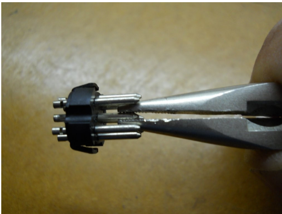
Foto 3: Remoção do pino central com um alicate de bico fino
