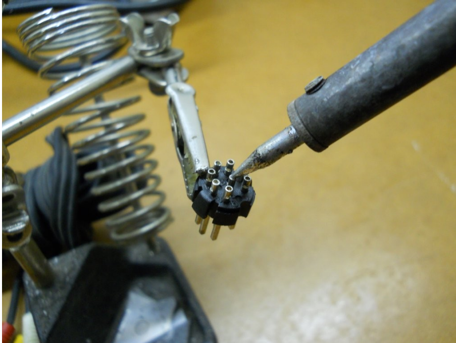
Foto 2: Pino central é aquecido para facilitar a retirada
