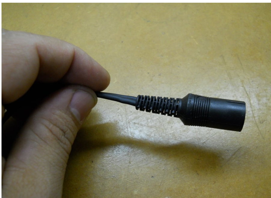
Foto 5: Passe o cabo pela capa plástica (e pela casca metálica, se necessário)
