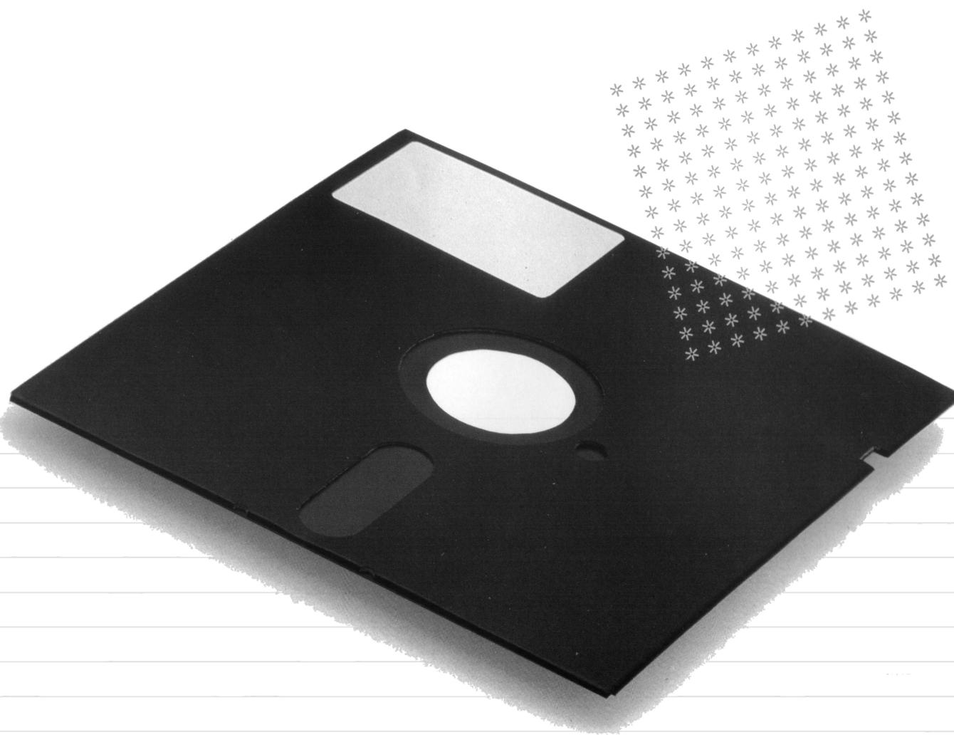
La disquette Master qui est fournie avec l'unité de disques contient le système d'exploitation de disques : SED (en anglais, DOS pour Disk Operating System), qui permet à l'unité et à l'ordinateur de stocker des programmes et des fichiers, de charger des fichiers dans l'ordinateur, de faire des copies de disquettes, etc.
