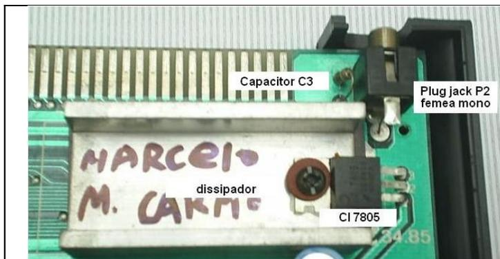
Remover C3, plug P2, dissipador e o CI 7805.
