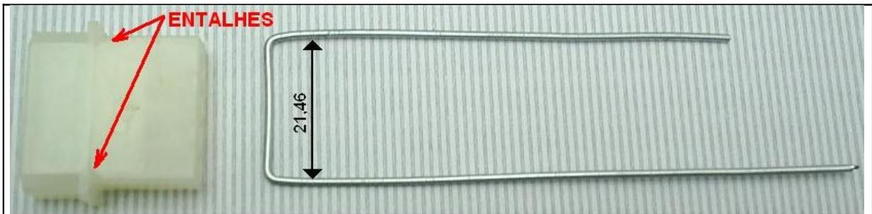
Dobre o arame no formato de “U” conforme a medida do conector. Para obter dobras melhores use uma mini-bigorna ou outro suporte de ferro. (medidas em milímetros). Observe que foram feitos dois entalhes nas arestas do conector conforme indicado em vermelho para o encaixe do arame.
