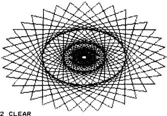
2 CLEAR 10 DIM a(36): DIM b(36) 15 LET 1=120: LET j=80 17 FOR h=1 TO 5 20 FOR n=1 TO 36 30 LET k=n/18\*PI 40 LET a(n)=128+1\*SIN k: LET b(n)=88+j \*COS k 45 PLOT a(n),b(n) 50 NEXT n 60 FOR n=1 TO 36 65 LET m=n+12 70 IF m>36 THEN LET m=m-36 80 LET ox=a(m)-a(n)90 LET by=b(m)-b(n) 100 PLOT a(n),b(n): DRAW ox, oy 110 NEXT n 120 LET l=1/2: LET j=j/2
