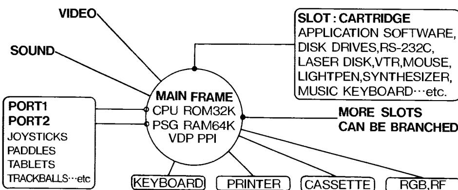
К расширителям магистрали могут подключаться кассеты ПЗУ или другие расширители магистрали для расширения возможностей ЭВМ.
