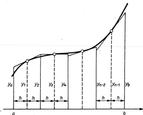
Bild 28. Zur Ableitung der Tangentenformel
