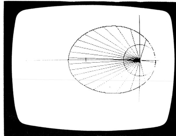
Bild 18. Satellitenflugbahn ( $v_0 = 10 \text{ km/s}$ )
