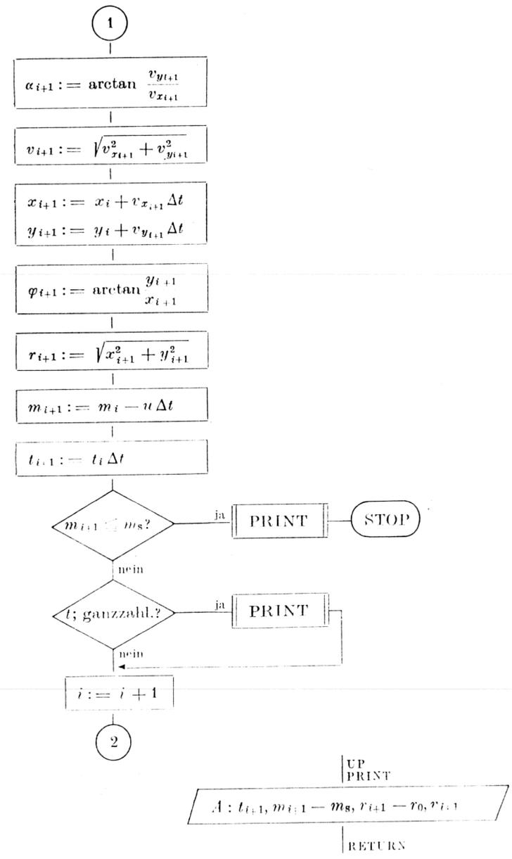
Bild 24. Programmablaufplan zum Raketenstart
