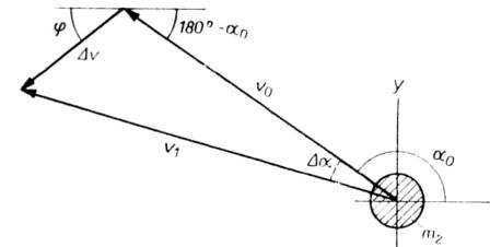
Bild 16. Geschwindigkeitsdreieck zur Berechnung von Satellitenbahnen
