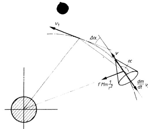
Bild 22. Geschwindigkeitsdreieck zur Berechnung der Raketenbewegung
