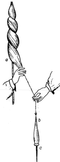
Bild 34. Handspinnen mit Rocken (*a*), Spindel (*b*) und Schwungmasse (*c*)
