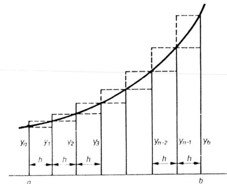
Bild 27. Zur Ableitung der Trapezformel
