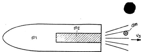
Bild 21. Rückstoßprinzip einer Rakete
