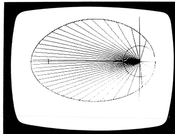
Bild 20. Satellitenflugbahn ( $v_0 = 10,35$  km/s)
