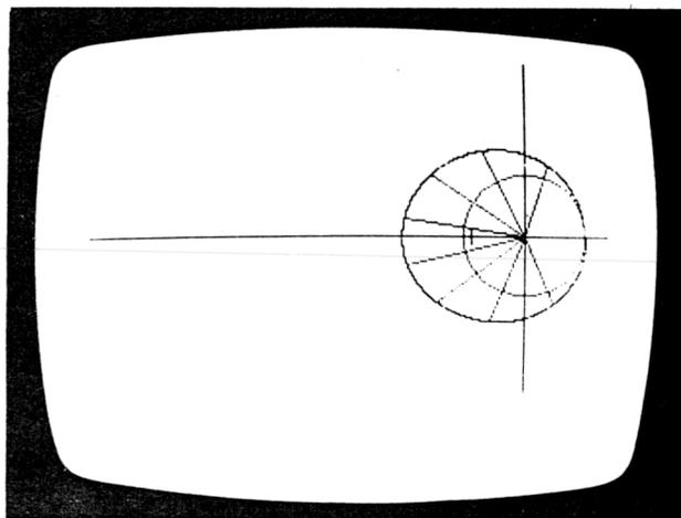
Bild 19. Satellitenflugbahn ( $v_0 = 9$  km/s)
