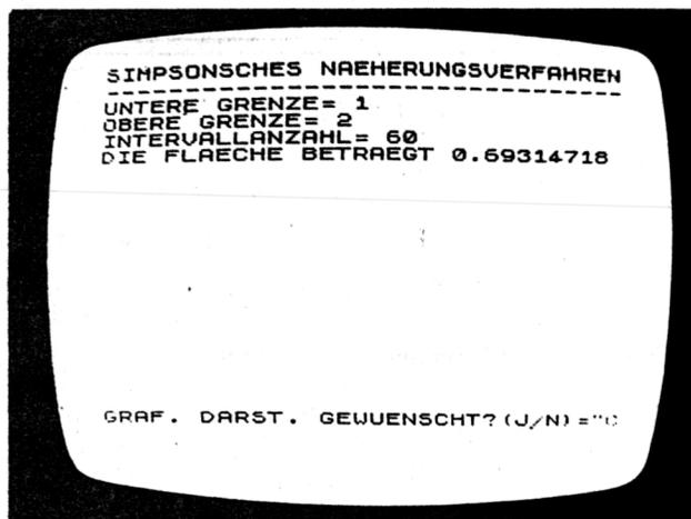
Bild 29. Simpsonsches Näherungsverfahren
