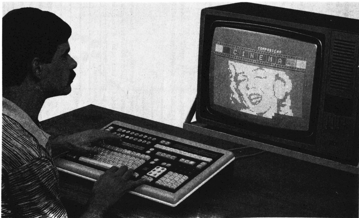
Fig.38 TERMINAL DE COMPOSIÇÃO "FIET" (TERMINAL FRANCES)
