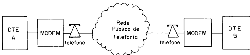
Figura 9.3 - Ligação ponto a ponto comutada.
