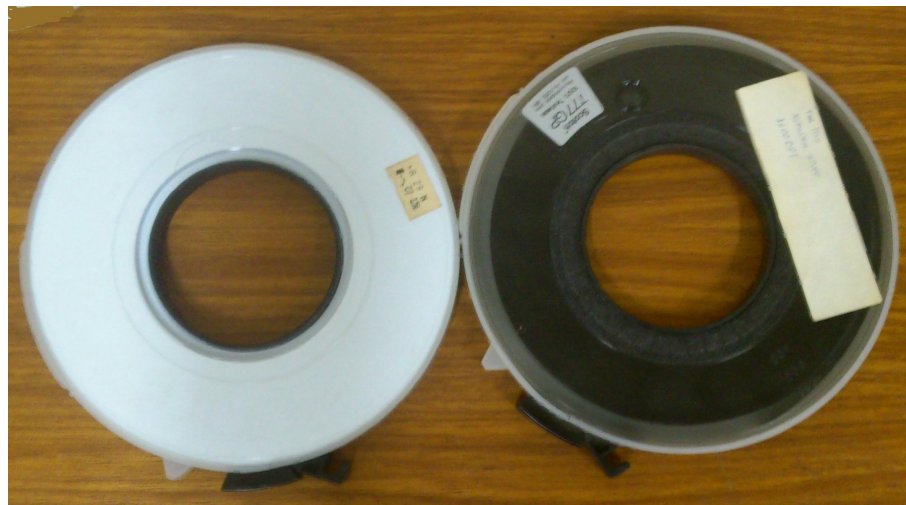
Figura 3.3: Exemplo Verso e Frente de uma fita magnética.
