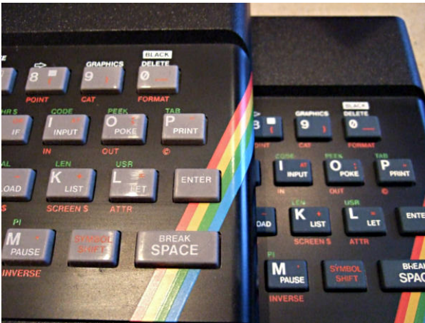
Confronto tra i colori dei tasti della Serie 1 (a sinistra) e della Serie 2 (a destra).
