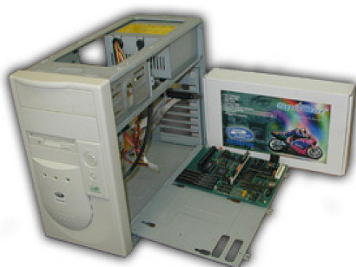
Scheda madre Sprinter con scatola e assemblata in case minitower
