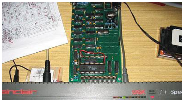
MB-02+ con 512 KB SRAM a chip singolo connessa a un +2
