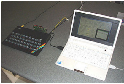
Una ZXMMC+ collega uno Spectrum 48K a un PC via USB
