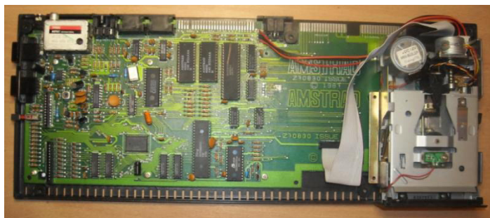
La scheda madre del +3, serie 1. Come si vede, è stata notevolmente semplificata rispetto a quella del +2.
