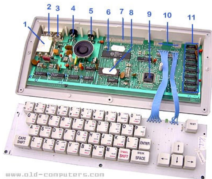
Schema interno del Didaktik M: 1-modulatore RF, 2-connettore cavo TV, 3-connettore monocromatico per monitor, 4-ingresso DIN per l'alimentatore esterno, 5-ingresso/uscita DIN per il registratore, 6-micro-processore Zilog Z80A, 7-porta espansione I/O, 8-chip dei 16 KB di ROM, 9-chip ULA di fabbricazione sovietica, 10-connettori joystick compatibili Kempston (sinistra) e Sinclair (destra), 11-banchi dei 64 KB RAM di fabbricazione sovietica.
