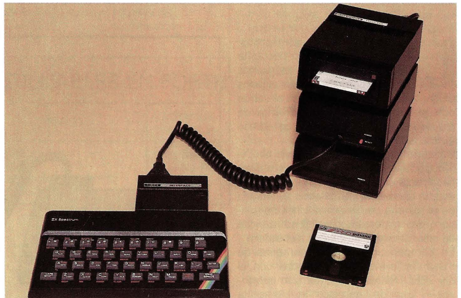
Aspecto "al completo" del sistema de almacenamiento en disco INVESDISK-200. Este consta de la fuente de alimentación, la unidad lectora de discos, el controlador y el módulo de interface asociado directamente al ZX-SPECTRUM.
