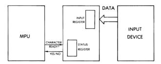
Fig. 6.8a: Handshaking (Input)
