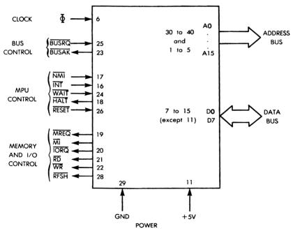
Fig. 2.33: Z80 MPU Pinout
