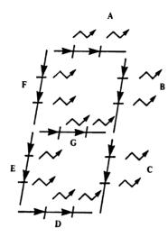
Fig. 6.10: Seven-Segment LED
