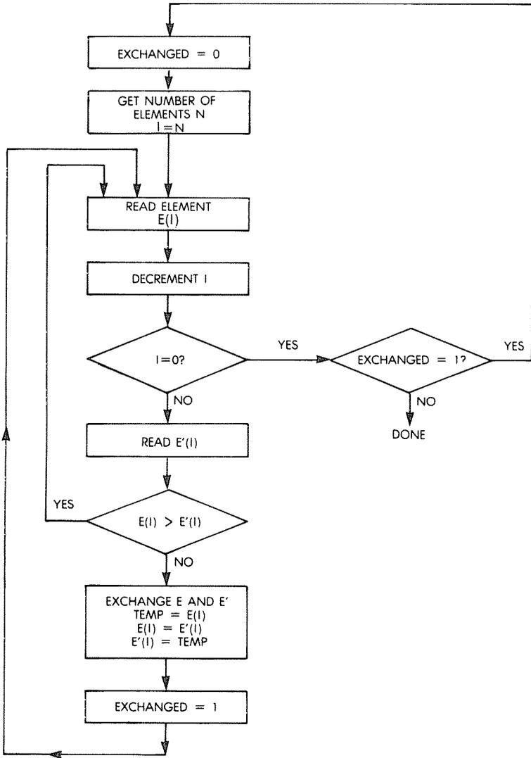
Fig. 8.7: Bubble-Sort Flowchart
