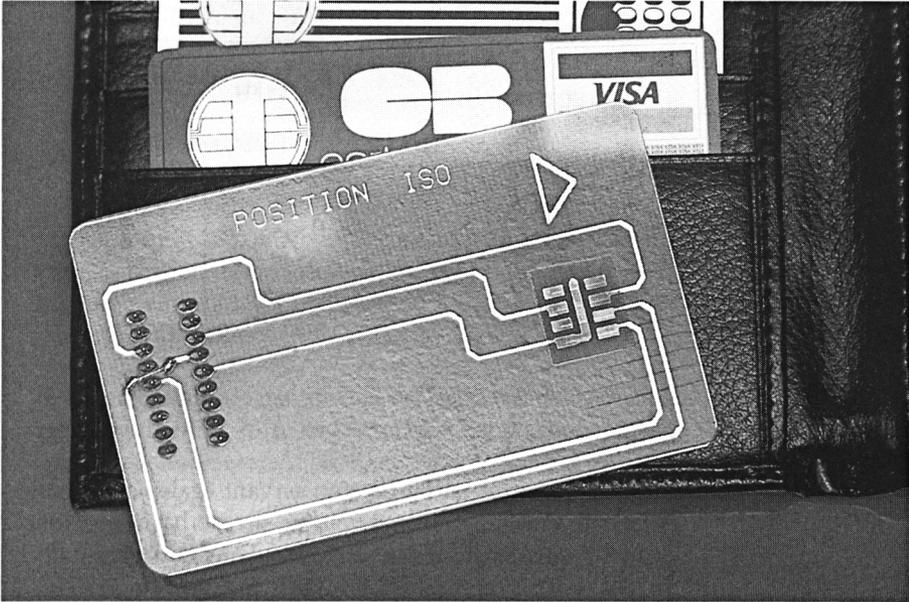
Le cadencement de ces transmissions est confié à un signal d'horloge fourni à la carte par le lecteur dans lequel on l'introduit, de telle façon que pour une fréquence d'horloge de 3,58 MHz environ le rythme de modulation soit de 9600 bits par seconde.
