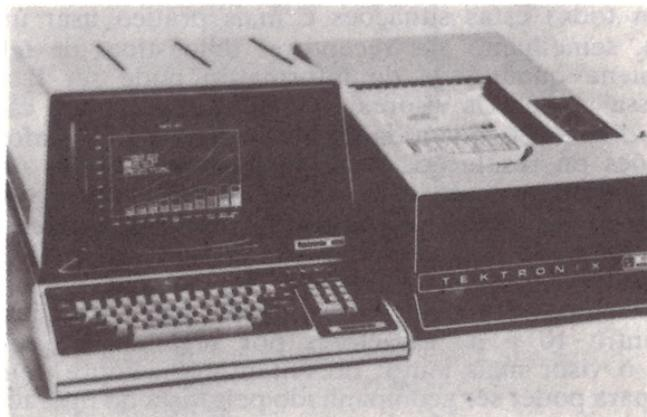
**Fig. 27.** – Terminal gráfico ligado a uma unidade impressora (à direita)
