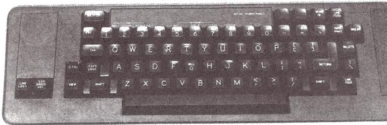
**Fig. 7.** – Um teclado de computador. Note o teclado QWERTY e as teclas de funções.
