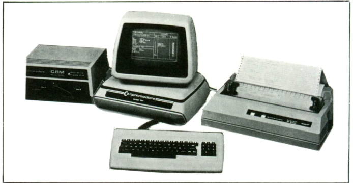
Configuración típica de computador personal para gestión de pequeños negocios: CPU con monitor, lector de discos flexibles (floppys), impresora y teclado independientes. (Cortesía: Commodore).
