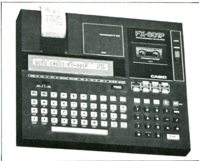
Computador personal portátil, que incorpora impresora y microcassette, así como teclado alfabético y numérico separados. (Cortesía: Casio).
