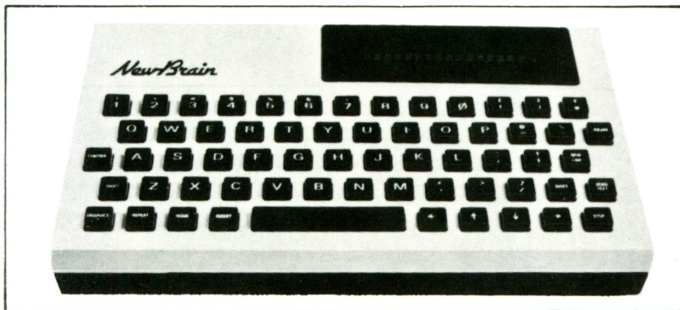
Detalle de un computador personal para aplicaciones domésticas. Obsérvese el teclado Qwerty con indicador digital. (Cortesía: New Brain).
