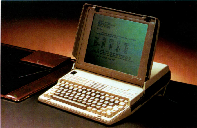
Un computador personal portátil. Obsérvese que la pantalla se abate sobre el teclado y permite su traslado de un lugar a otro cómodamente. (Cortesía: Data General).
