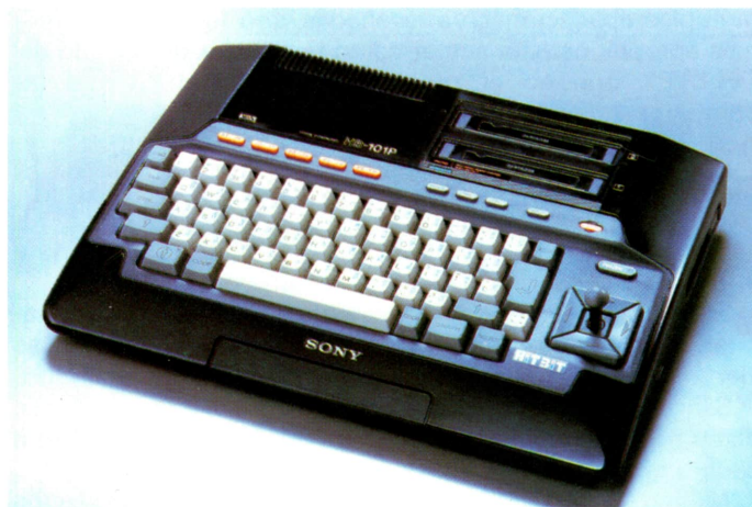
Computador personal de pequeño tamaño, en el que la CPU está integrada en el mismo módulo del teclado. Este equipo está basado en el sistema operativo MSX. (Cortesía: Sony).
