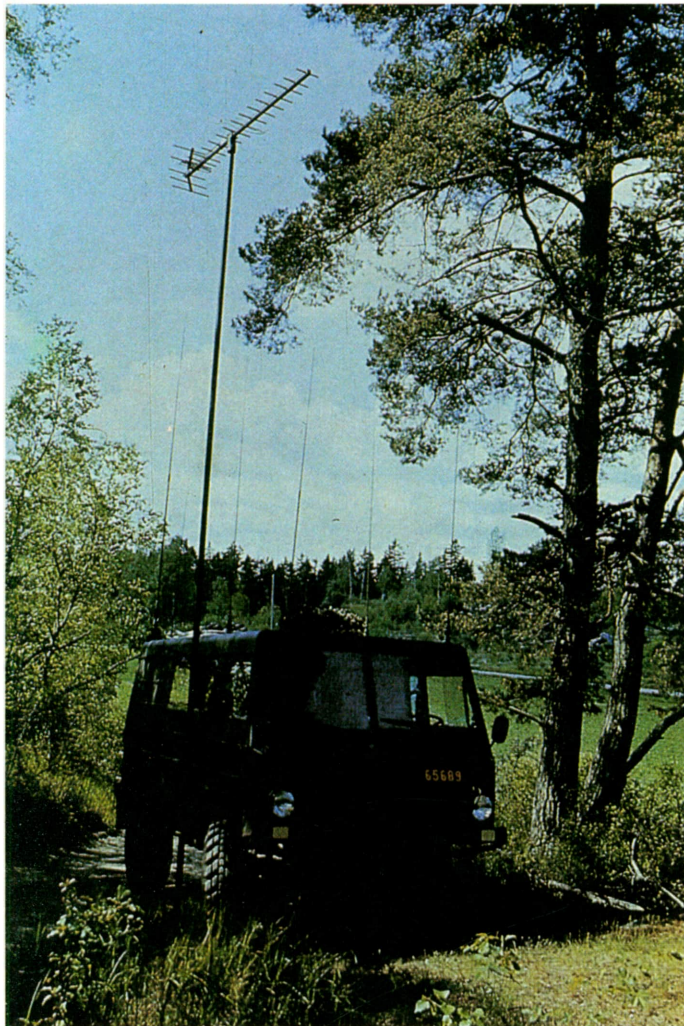
Vehículo militar de comunicaciones, dotado de siete antenas verticales y una antena del tipo directivo de VHF. (Cortesía: Amper, S.A.)
