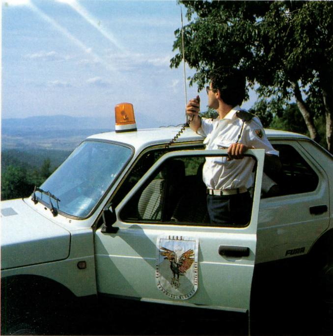
Antena de tipo vertical, adaptable a vehículos, que permite comunicaciones móviles, directamente o por vía repetidor.
