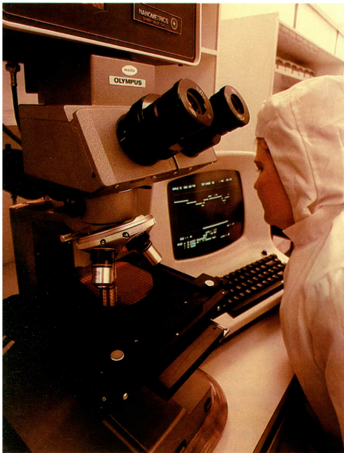
Verificación final de un lote de chips de microprocesador antes de proceder a su encapsulado. Con el instrumental adecuado, se comprueba la respuesta electrónica con todas las señales para las que trabajará posteriormente. (Cortesía: AMD).
