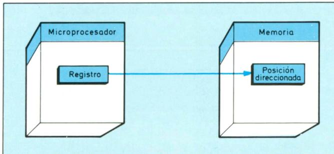
*Figura 45. Esquema sinóptico de transferencia del contenido de un registro a la memoria.*
