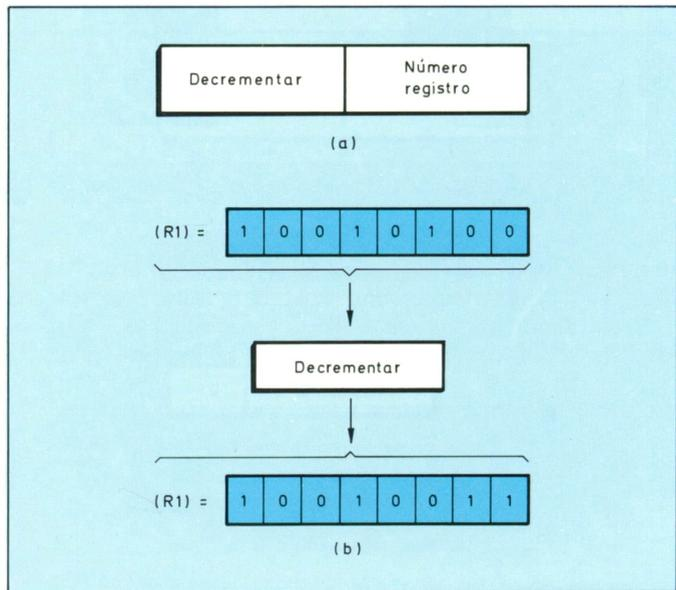
Figura 56. a) Instrucción de decrementar un registro; b) Ejemplo de decrementación de un registro.
