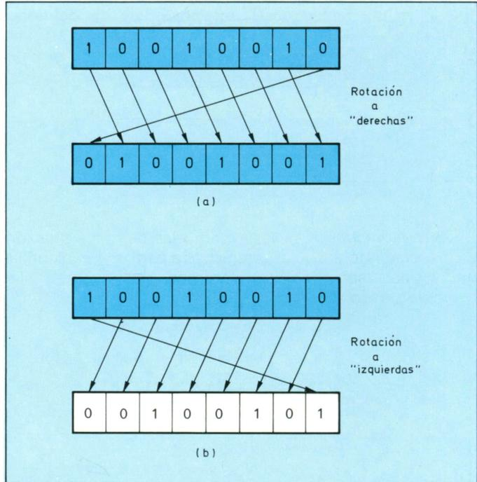
Figura 58. a) Rotación a derechas de un registro; b) Rotación a izquierdas de un registro.
