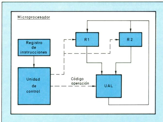
Figura 53. Señales internas del microprocesador para ejecutar una operación entre registros.
