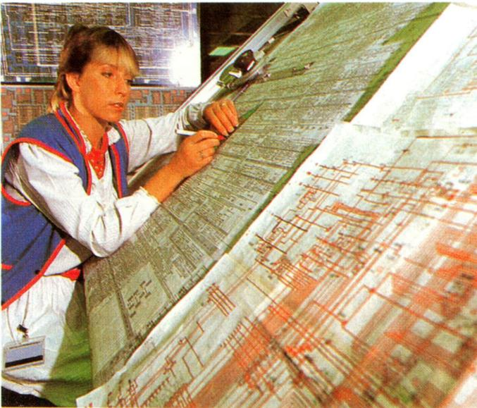
*La fabricación de microprocesadores es muy laboriosa. En primer lugar hay que diseñar el esquema teórico, y después dibujar a una escala ampliada, la totalidad de las máscaras que determinan las diferentes fases de fabricación.*
