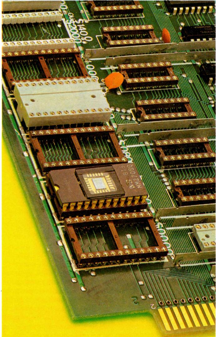
*Las memorias exteriores, EPROM en la figura, soportan el firmware de los microprocesadores.*
