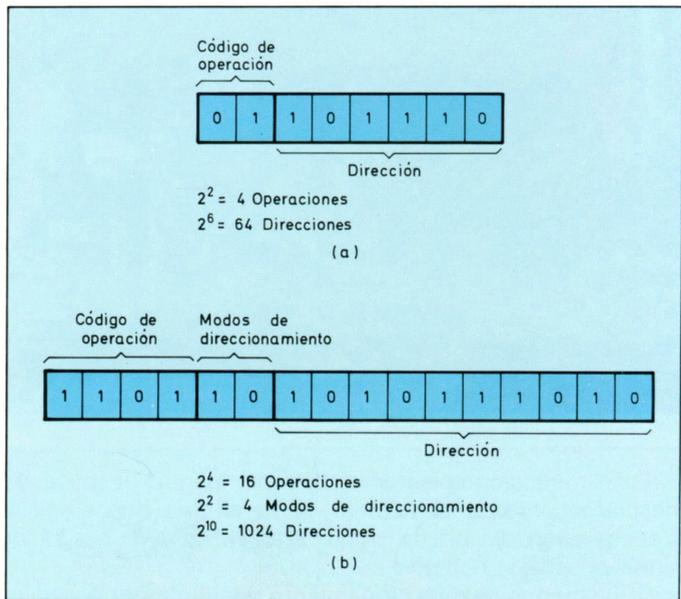
*Estructura de instrucciones de 8 bits (a) y de 16 bits (b) más corrientes, incluyendo código de operación y modos de direccionamiento.*
