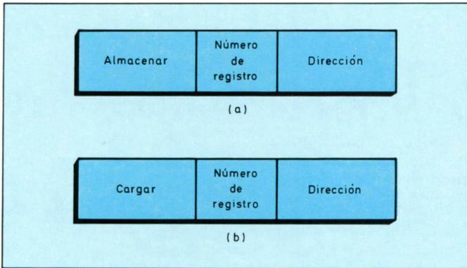
Figura 48. Cargar un determinado registro (b) y almacenar en memoria su contenido (a), mediante instrucciones formateadas para microprocesadores de más de un registro.
