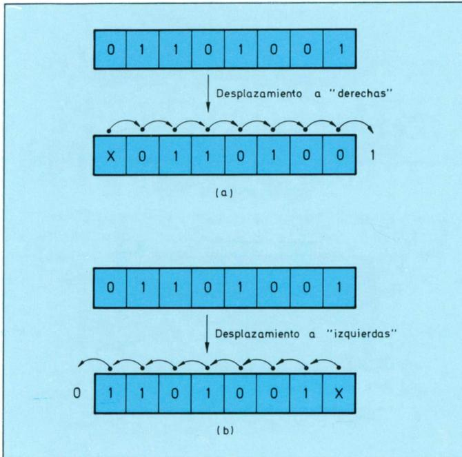
Figura 57. a) Desplazamiento a derechas de un registro; b) Desplazamiento a izquierdas de un registro.
