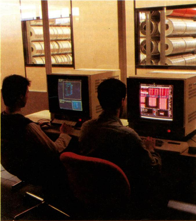
*El diseño de circuitos integrados mediante computador se está imponiendo, especialmente desde que la tendencia actual se orienta hacia la fabricación de dispositivos bajo pedidos especiales, que realicen unas funciones predeterminadas. El computador facilita la introducción de cambios sobre el diseño previsto. (Cortesía: Texas Instruments).*
