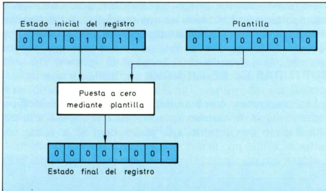
Figura 59. Puesta a cero de un registro mediante plantilla o máscara.
