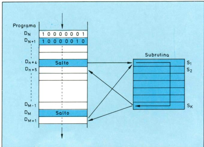
Figura 22. Representación esquemática del funcionamiento de una subrutina.
