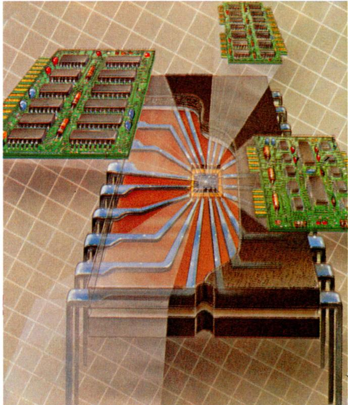
*Los microprocesadores se intercomunican fácilmente y de forma física con el exterior, a través del conjunto de terminales que llevan incorporados.*
