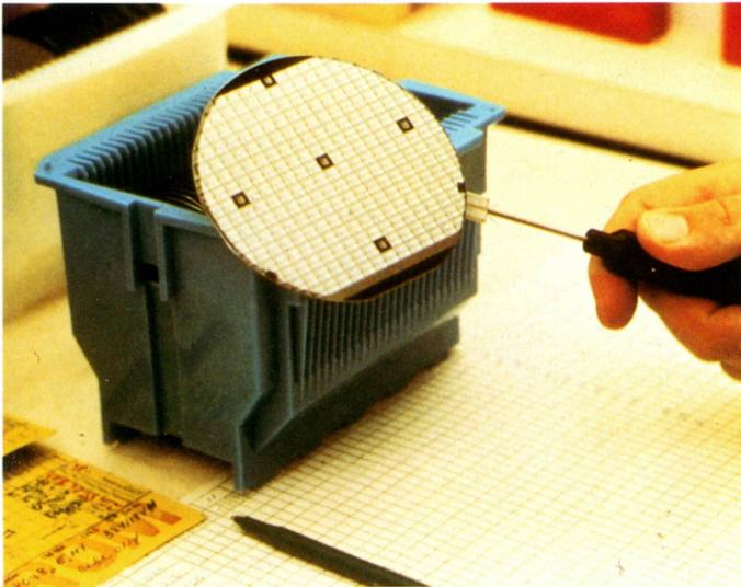
*Fase del proceso de fabricación de circuitos integrados, donde se muestran los diferentes elementos que se obtienen de una oblea. (Cortesía: Intel).*
