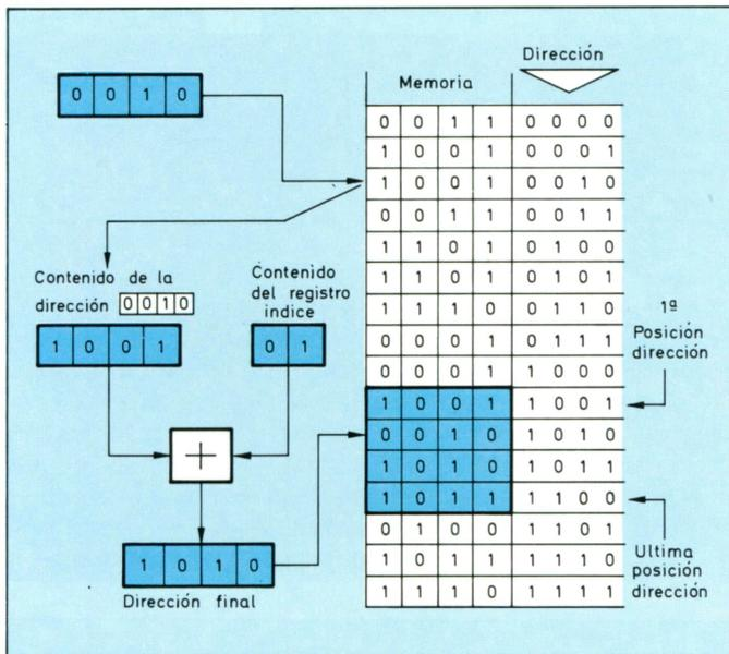
Figura 38. Direccionamiento postindexado.
