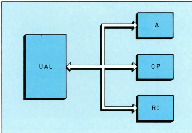
*Buses internos de la CPU de un microprocesador: interconexión entre la UAL (unidad aritmético-lógica), el acumulador, el registro de instrucciones y el control de procesos.*
