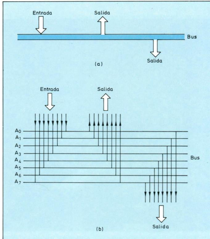
Figura 9. a) Representación esquemática de un bus con entrada y salidas; b) Representación eléctrica equivalente del bus anterior. En ambos casos no se consideran las posibles conexiones y desconexiones eléctricas producidas por puertas de tres estados (tri-state).
