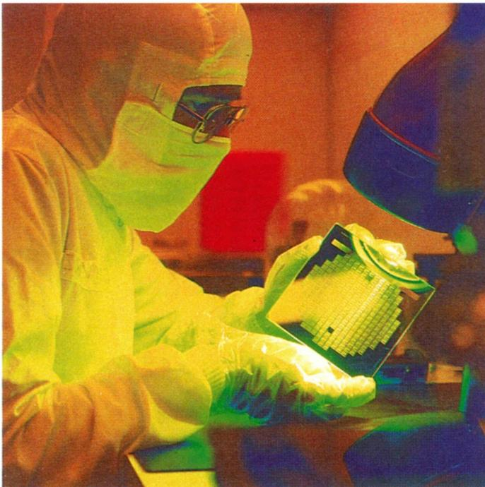
*Inspección ocular de una de las máscaras reducida a tamaño natural, para la fabricación de circuitos integrados sobre una oblea.*
