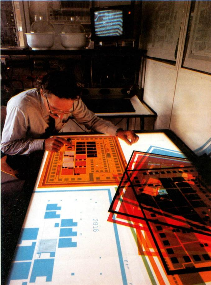
*Comprobación microscópica de cada zona de las máscaras que darán lugar a las diferentes fases de elaboración. Esta misión debe realizarse especialmente en los puntos donde hay conductores muy próximos, en zonas de reducido espesor, etc. (Cortesía: AEG).*
