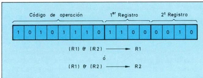
Figura 52. Formato de una instrucción de 16 bits de operación entre registros y representación nemónica de dicha operación, almacenando el resultado en cada caso en uno de los dos registros.
