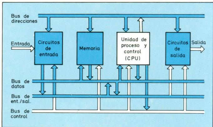
Figura 7. Estructura básica de un microprocesador. Se destaca la unidad central de proceso y control, así como el bus de control.
