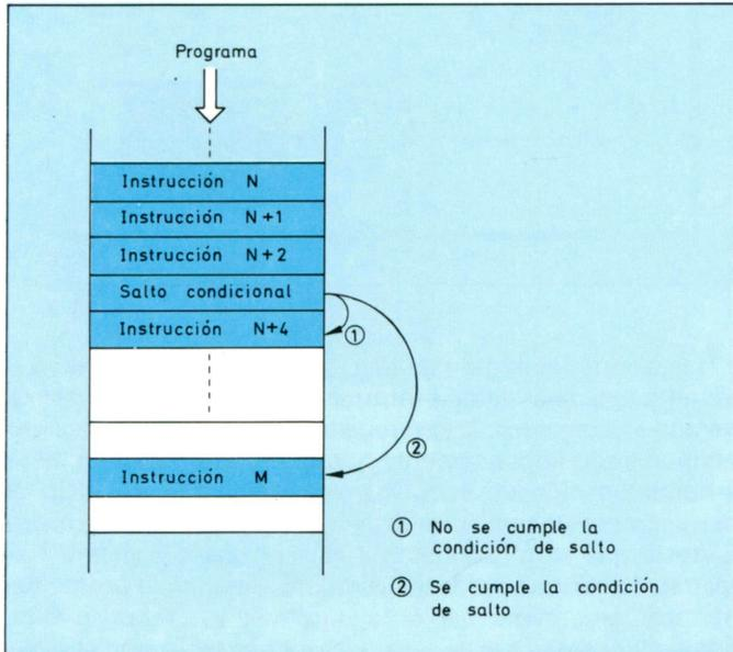
Figura 60. Instrucción de salto condicional. Diagrama de funcionamiento.
