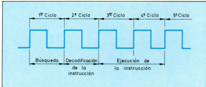
La mayor o menor frecuencia del oscilador de sincronismo del microprocesador no es la única componente a tener en cuenta para afirmar si un microprocesador es capaz o no de realizar determinada instrucción más aprisa que otro. La organización del trabajo en la CPU y la rapidez de actuación de los circuitos de entrada/salida, condicionan en mayor
