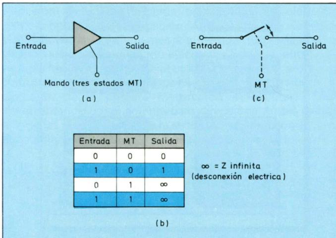
Figura 10. a) Esquema eléctrico equivalente de una puerta de tres estados; b) Tabla de verdad de una puerta «tri-state»; c) Simil eléctrico clásico de una puerta «tri-state».
