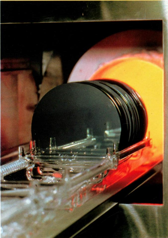
*Los hornos de difusión requieren una temperatura suficiente para que los portadores de carga, las sustancias dopadoras, dispuestas normalmente en forma gaseosa, puedan difundirse en las zonas de la oblea que previamente han dispuesto las máscaras. (Cortesía: Standard).*
