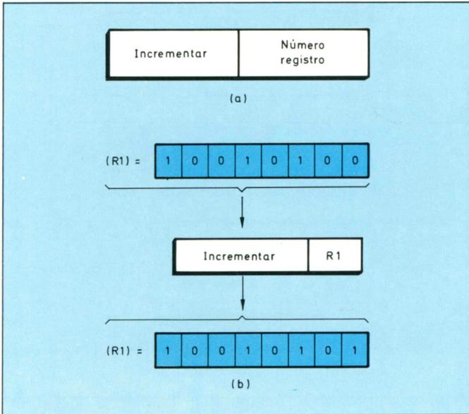
Figura 55. a) Instrucción de incrementar un registro; b) Ejemplo de incrementación de un registro.
