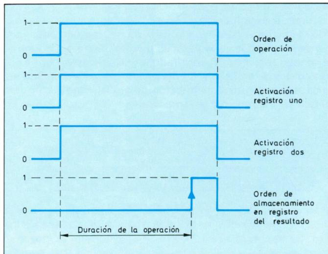
Figura 54. Diagrama de tiempos de las señales de mando proporcionadas por la CPU, para ejecutar una operación entre registros del microprocesador.
