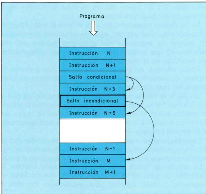
*Figura 62. Salto incondicional en una secuencia de instrucciones en la que se incluye un salto condicional.*
