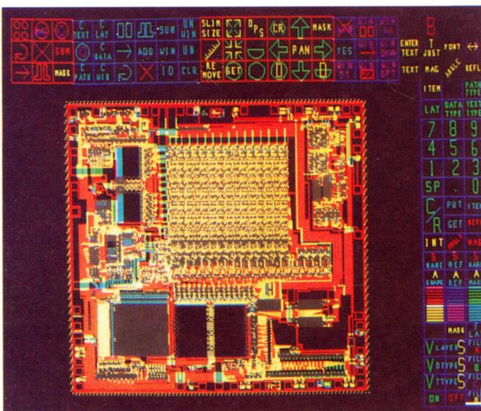
En esta figura se muestra las posibilidades de diseñar microprocesadores y, en general, circuitos integrados, empleando el computador (CAD). Los diferentes colores señalan las partes diferenciadas del conjunto. (Cortesía: ITT Semiconductors).
