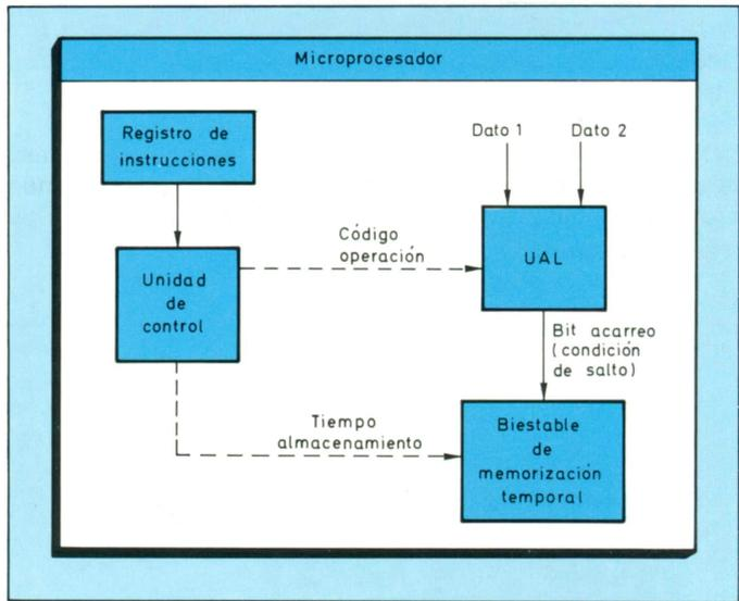
Figura 61. Señales internas al microprocesador con el fin de almacenar temporalmente el bit de acarreo como resultado de determinada operación.
