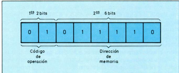
*Figura 13. Formato frecuente de una instrucción de 8 bits en donde se detalla el código de operación y la dirección de la memoria.*
