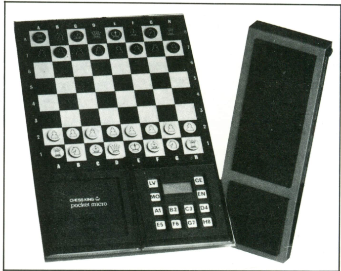
Juego electrónico de ajedrez, que posee cuatro niveles de dificultad, a elección del contrincante que se opone a la máquina.
