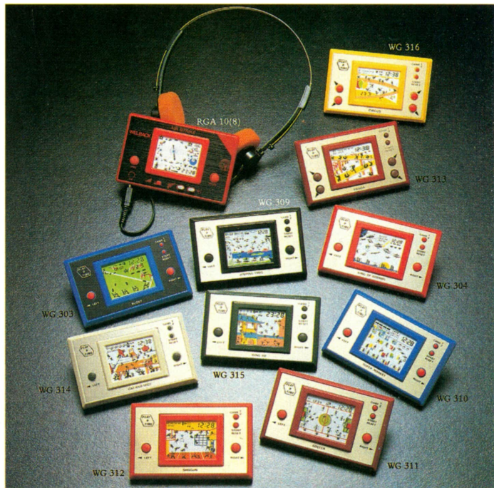
Figura 45. Amplia muestra de videojuegos de bolsillo basados en la técnica del cristal líquido. Algunos modelos incorporan un reloj digital e incluso un receptor de radio. Su popularización es tal, que su precio de venta es realmente módico.
