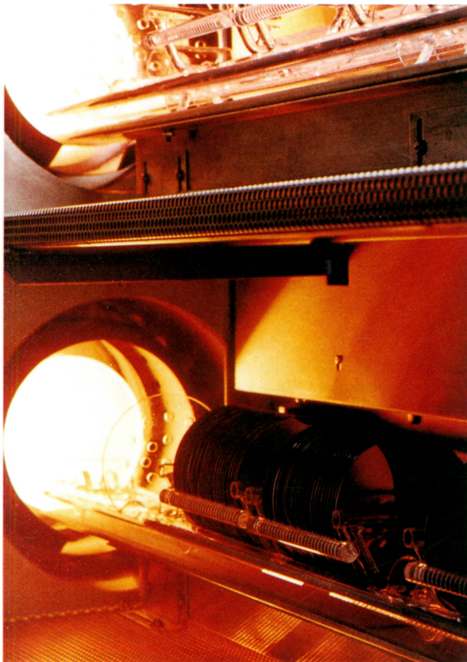
Horno de difusión y oxidación, en donde se incorporan los elementos que efectúan el dopado de las obleas. (Cortesía: Laboratorio de Investigación de Kodak).
