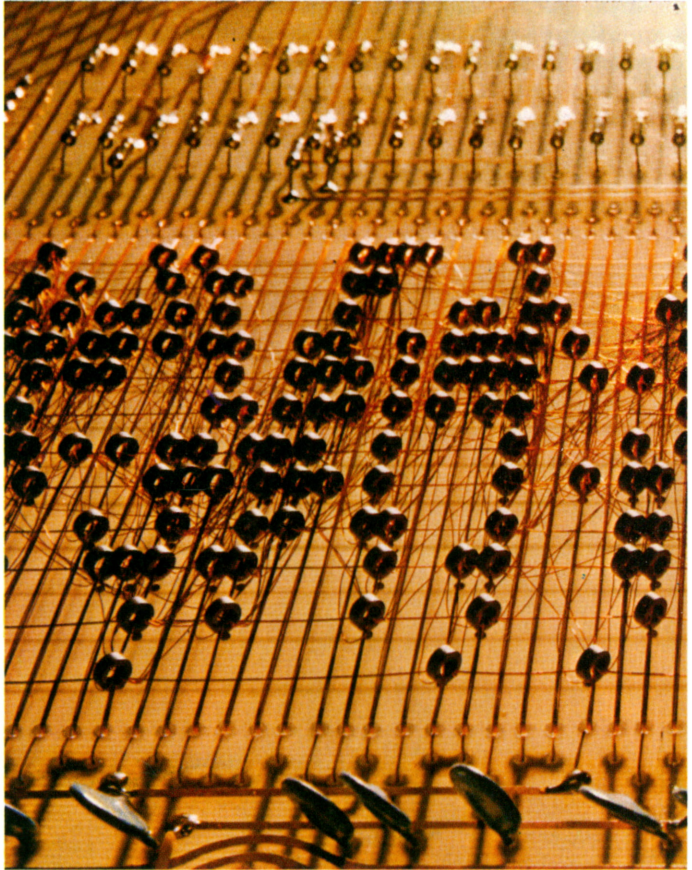
Circuito de memoria resuelto con núcleos de ferrita toroidal. Este tipo de complejas estructuras constituían las memorias de los antiguos computadores.
