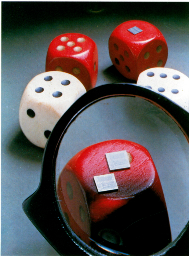
En la fotografía se observa el tamaño de un chip en el que se incluyen cientos de miles de dispositivos activos, que configuran circuitos específicos, entre los que se encuentran las memorias de gran capacidad. (Cortesía: British Information Services).
