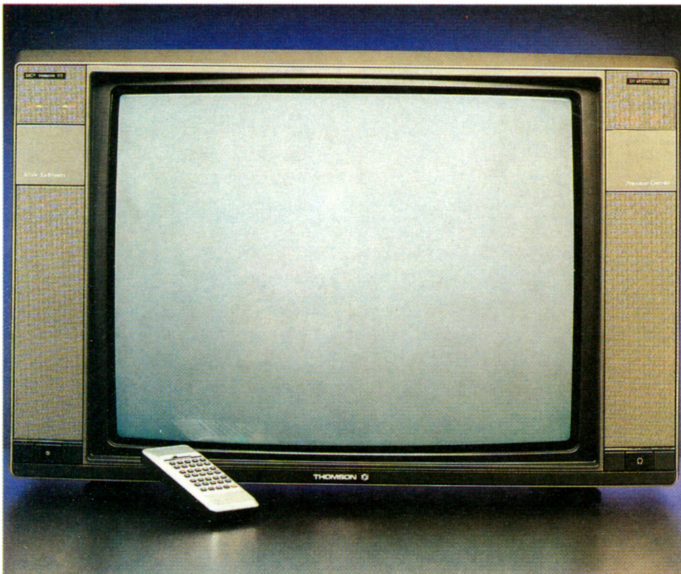
Televisor color «Full Square». Este modelo presenta un formato de pantalla prácticamente rectangular, que consigue aprovechar la práctica totalidad de las esquinas de la pantalla, al tiempo que mejora su estética. (Cortesía: Thomson).
