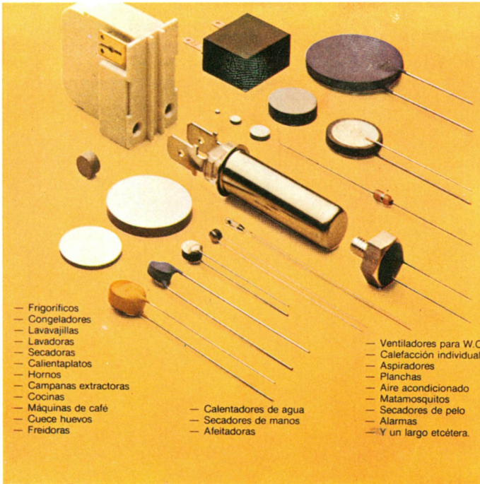
Figura 2. Termistancias para aplicación en electrodomésticos. También se citan algunos casos concretos de utilización. Esta relación no pretende ser exhaustiva, sin embargo, es suficiente para que el lector tenga una idea general de las principales aplicaciones domésticas.
