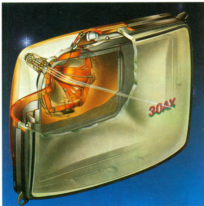
Vista en sección de un tubo 30 AX de la firma Philips. Se observa la trayectoria que sigue el haz de electrones desde el cátodo y a través del espacio existente entre las bobinas deflectoras.
