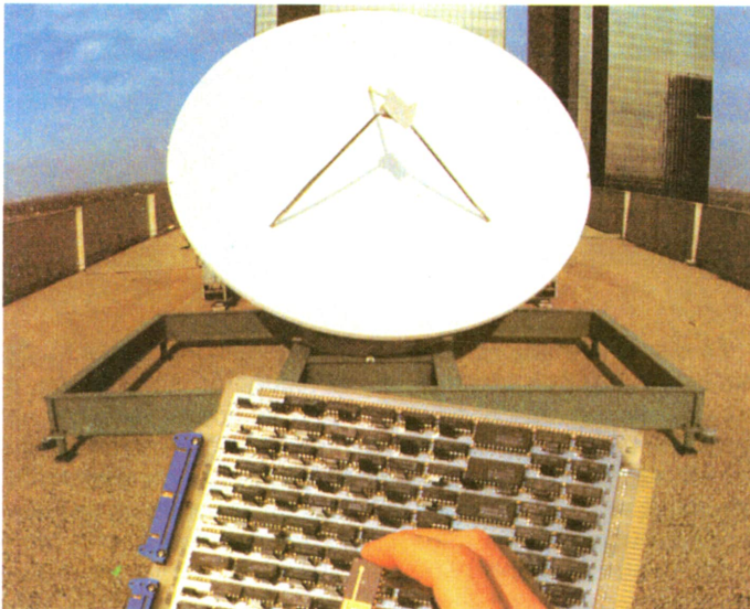
Procesador digital de señal TMS 320, formando parte de un modulador/demodulador, empleado en las comunicaciones de TV vía satélite. (Cortesía: Texas Instruments).
