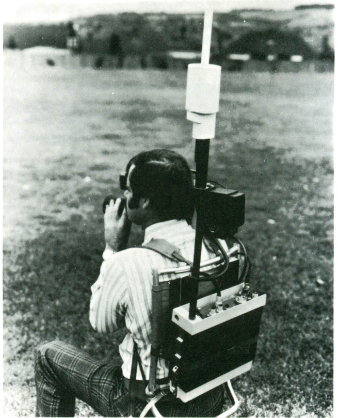
Cámara autónoma con antena de microondas, que envía la señal captada a una unidad móvil o a un centro emisor más o menos próximo.
