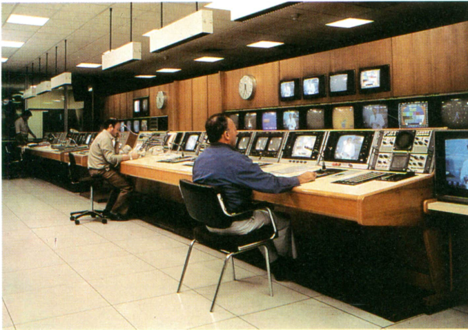
Aspectos que presenta una parte del control central de TVE en Torrespaña (Madrid). En cada punto, se evidencian los monitores que permiten conocer las imágenes de cada cámara o de cada enlace.
