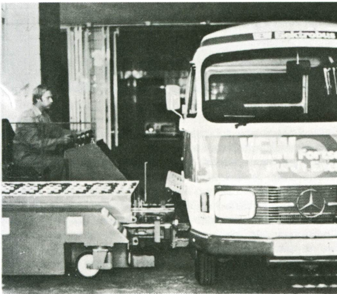
Otro dispositivo para el cambio de baterías en un automóvil eléctrico. Este va destinado a las furgonetas tipo VW de Mercedes Benz.
