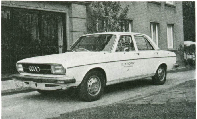
Este coche eléctrico es capaz de alcanzar una velocidad de hasta 90 km/h, con un motor de 18 a 32 kW y un grupo de baterías de 144 V y 125 Ah.
