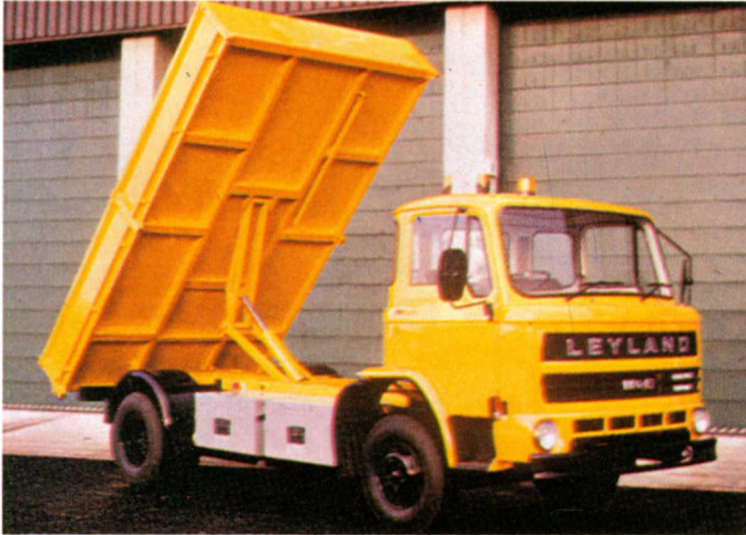
Camión volquete que extrae toda su energ3a de las bater3as el3ctricas incorporadas en los laterales, aprovechando el espacio que queda entre las ruedas delanteras y traseras.
