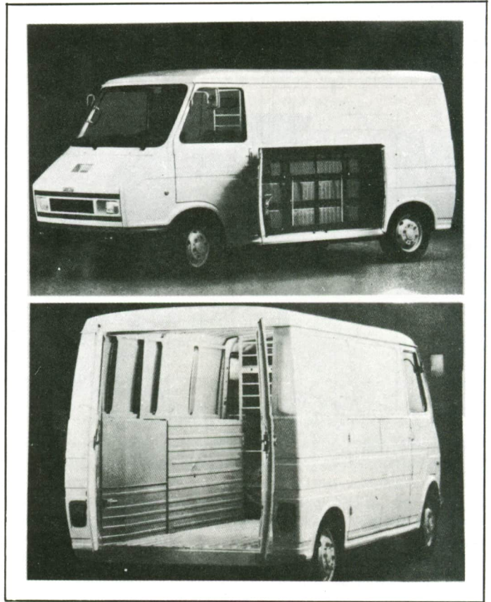
Furgoneta eléctrica Fiat modelo 242. En las fotografías se aprecia la curiosa disposición de las baterías en las paredes laterales del furgón.
