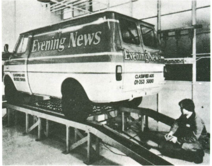
Cambio de baterías en una camioneta de reparto de periódicos, diseñada por la compañía Lucas.
