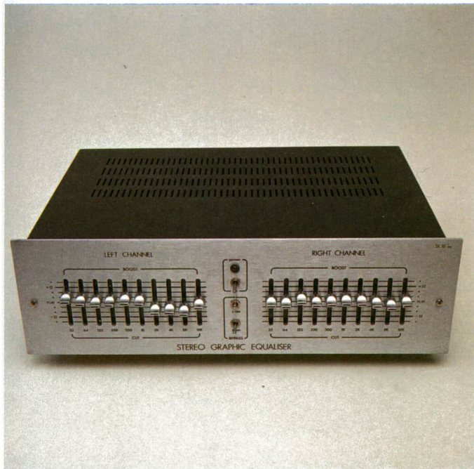
Ecualizador gráfico estereofónico, relativamente económico, con diez controles de frecuencia para cada uno de los canales.
