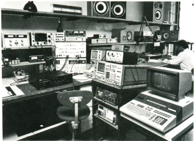
Disposición de un sistema de medida de la distorsión TIM. Obsérvese la gran cantidad de sofisticados equipos que se precisan para lograr unas mediciones fiables. (Cortesía: Vieta).
