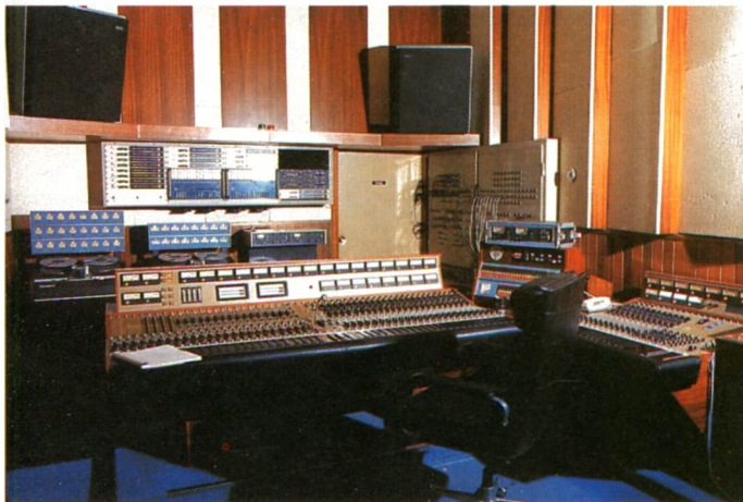
Sala de control de un estudio de grabación. En primer plano se pueden observar las mesas de control, con abundancia de controles de volumen y tono. Los circuitos ecualizadores, constituyen una parte importante de este tipo de mesas. (Cortesía: Gema).
