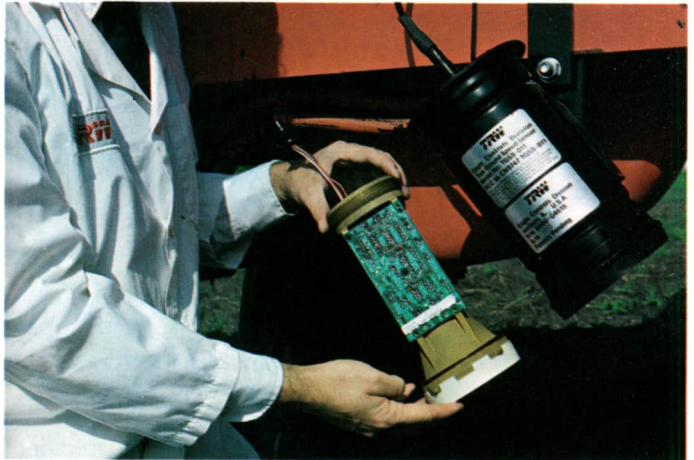
Figura 19. Vista interior de un radar para usos agrícolas. Concretamente su misión consiste en detectar la velocidad del vehículo respecto del suelo. (Cortesía: TRW e Industrias Jordá).
