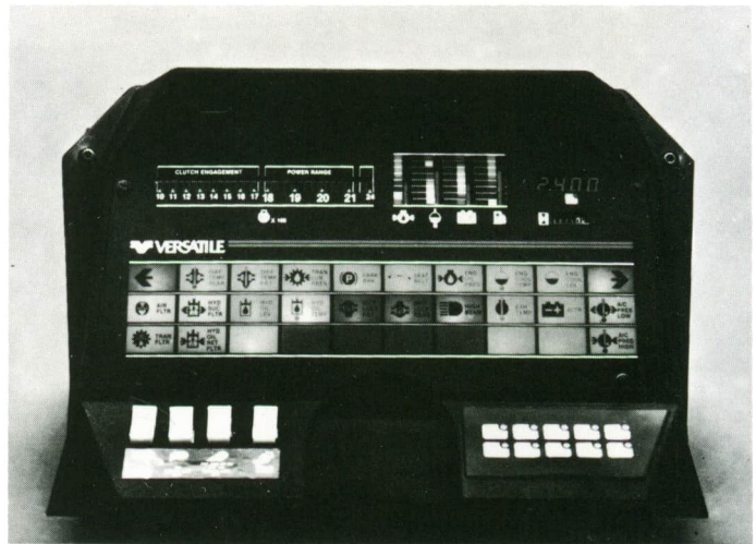
Figura 15. Sistema de protección de los elementos de transmisión de energía que monitoriza 23 funciones de prestaciones en un tractor (Versatile 1150 Tractor).
