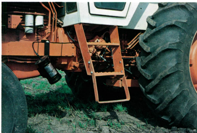
Figura 20. Radar instalado sobre un tractor para determinar la velocidad respecto del suelo y de este modo poder establecer una corrección instantánea.
