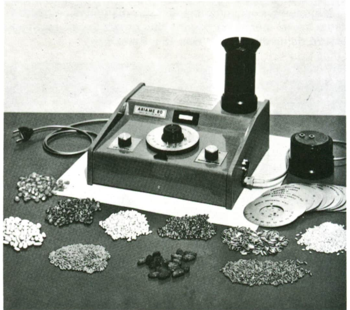
Medidor de la humedad de granos y semillas, según el método de las constantes dieléctricas y con escalas intercambiables. (Cortesía: Argos, S.A.).
