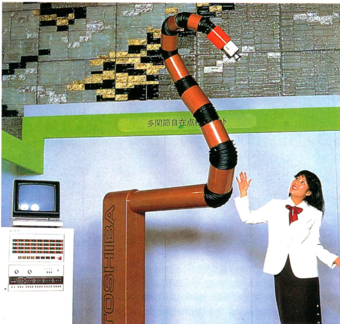
Robot dotado de un brazo explorador para ser empleado en zonas peligrosas o de difícil acceso. A la izquierda se observa el armario de control y el monitor, que permite observar las imágenes captadas por el robot de visión.
