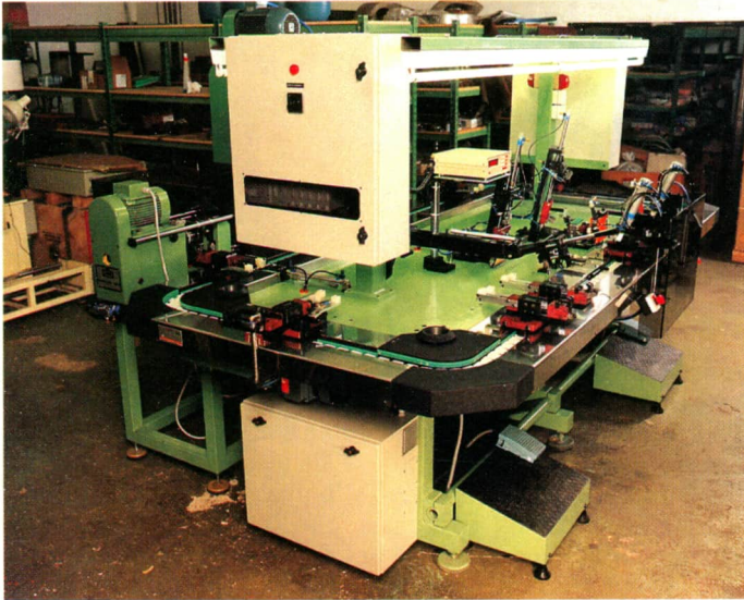
Máquina automática de concepto flexible tipo EMF, para el montaje y verificación de accesorios para el automóvil. (Cortesía: Emin, S.A.).
