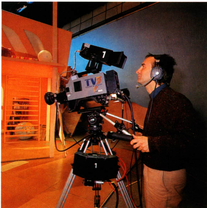
Micrófono de cascos. Lo utilizan los operadores telefónicos, locutores, cámaras de TV, pilotos, etc. Es imprescindible para aquellas personas que deben trabajar durante horas con el micrófono y precisan tener las manos libres. Deben ser elementos de escaso peso y bastante direccionales.
