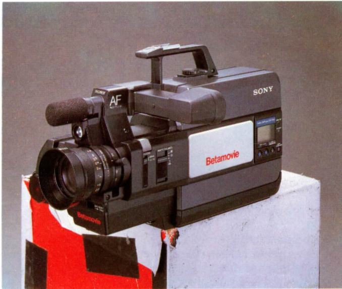
Las modernas cámaras de grabación de video incorporan un micrófono de gran direccionalidad, para captar los sonidos que se recogen delante de la cámara o las conversaciones del ambiente próximo. Se denominan «micrófonos de ambiente». (Cortesía: Sony)
