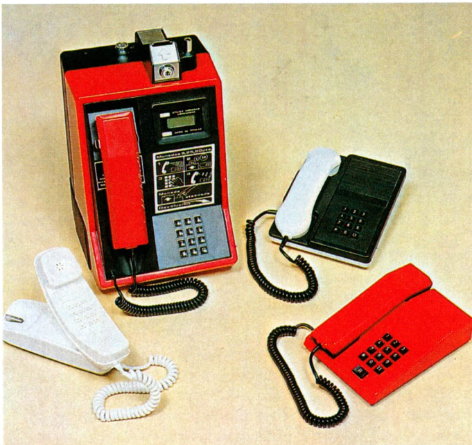
Los teléfonos incorporan también una pastilla microfónica para captar el sonido y poner en contacto a los dos comunicantes. En la fotografía se presentan varios modelos fabricados en España por Standard Eléctrica.
