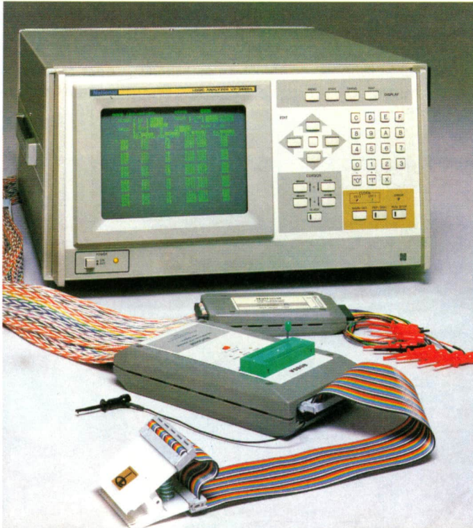
Analizador lógico para dispositivos que incorporan microprocesadores, con posibilidad de 32 canales y hasta 20 MHz. Se trata de otro de los modernos instrumentos que las nuevas tecnologías microelectrónicas hacen imprescindibles en todo laboratorio de diseño electrónico. (Cortesía: National).
