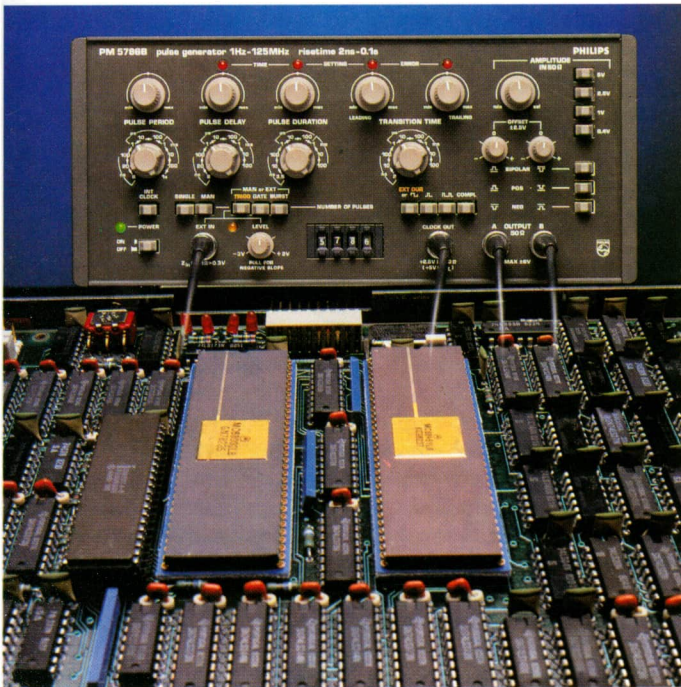
Instrumento generador de impulsos. Como muestra la fotografía, su aplicación resulta útil en el diseño y ajuste de la circuitería electrónica avanzada.
