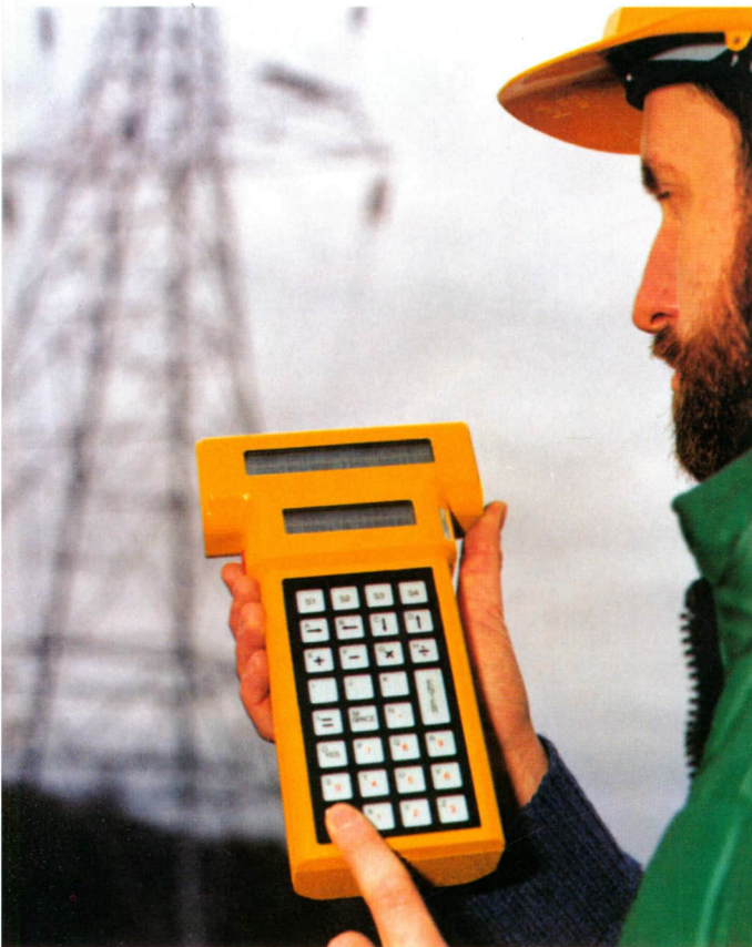
Microcomputador manual preparado para trabajar en ambientes contaminados como minas, almacenes de pinturas, instalaciones petroquímicas o petrolíferas, etc. Posee una capacidad de memoria de 128 k a la que se accede con los lenguajes Ensamblador y Basic. La lectura se efectúa en dos pantallas de cristal líquido. (Cortesía: Anderson Strathclyde).
