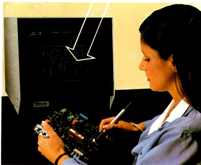
Sistema automático de detección de fallos de componentes. La operadora identifica, por contacto con la sonda, el componente defectuoso al cambiar la coloración de éste en la pantalla. (Cortesía: Marconi).
