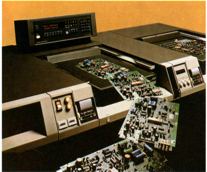
Sistema automático de test o verificación de circuitos impresos equipado con dos estaciones de trabajo simultáneo. (Cortesía: Marconi).
