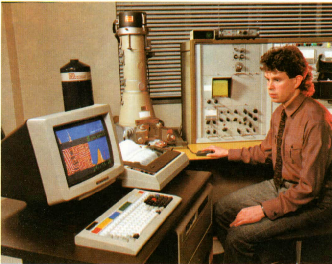
Telemicroanálisis por rayos X. Este sistema es capaz de medir, almacenar, analizar, presentar en pantalla y tratar las señales electrónicas y de rayos X producidas por microscopios electrónicos de exploración. Permite a los investigadores efectuar análisis en circuitos, en metalurgia y en otras aplicaciones. (Cortesía: Link Systems Ltd.)
