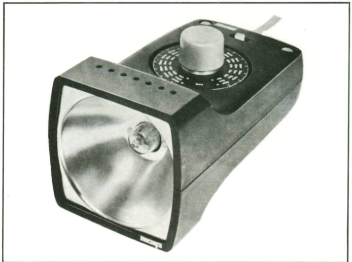
Figura 4. Estroboscopio portátil con mando de regulación de la frecuencia de los destellos. El sincronismo de los destellos con el movimiento cíclico que se pretende medir, permite la lectura directa sobre la escala de mando.
