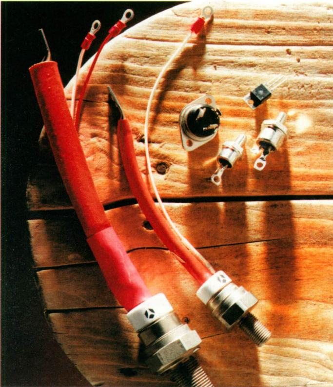
*Gama de triacs para el control y gobierno de motores universales y motores de inducción. El tamaño del componente refleja la potencia que son capaces de disipar. (Cortesía: Thomson CSF).*
