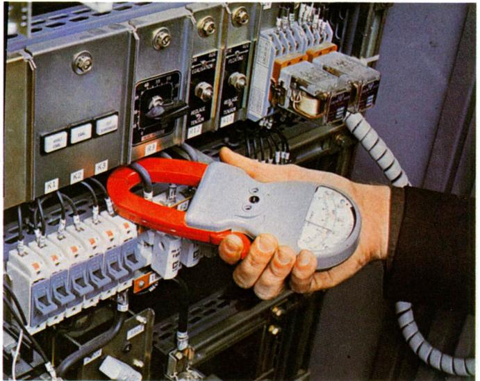
*Figura 21. Un amperímetro de pinza permite la medida de intensidades sin tener que desconectar el sistema. La simplicidad de la medida es evidente, como puede observarse en la medición efectuada en un cuadro eléctrico de distribución.*
