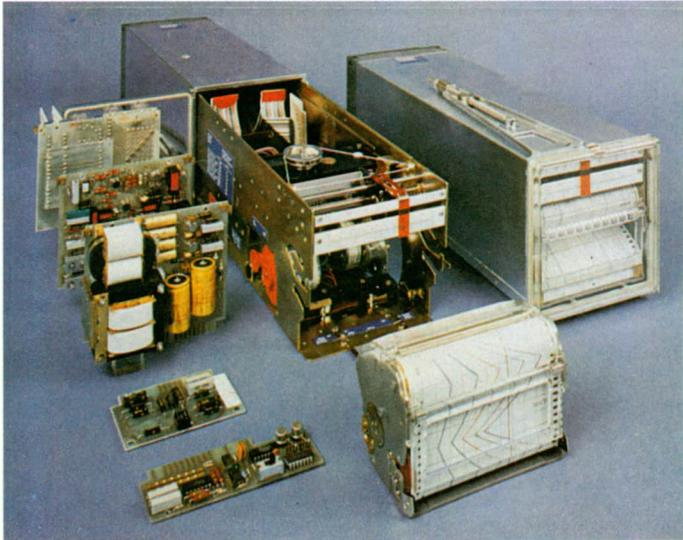
*Figura 35. Registrador de gráficos tipo empotrable con sistema de impresión indirecta, en el que se puede apreciar una elevada complejidad constructiva, tanto mecánica como electrónica.*
