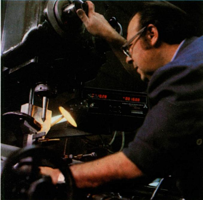
*Figura 4. En un sistema no regulado, como es el caso de la figura, es preciso accionar el mando de velocidad de la máquina-herramienta para mantener la velocidad cuando se carga mecánicamente el husillo portaherramientas.*
