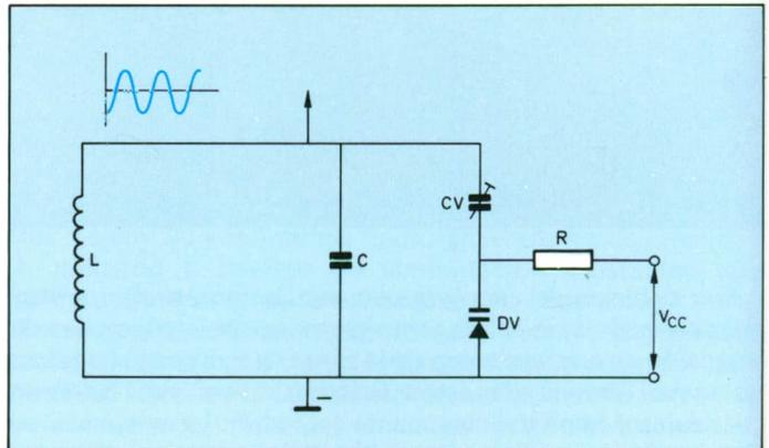
Figura 13. Célula de ajuste de circuito de control automático de frecuencia (AFC). Los elementos claves son un condensador variable y un diodo varicap.
