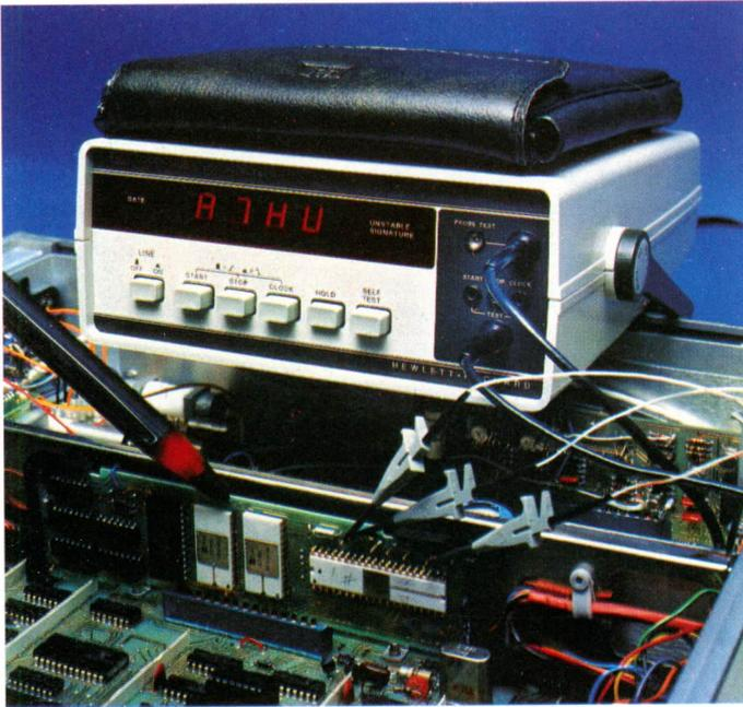
*La compleja circuitería electrónica que incluye circuitos integrados, memorias y microprocesadores en gran número, exige mediciones exactas. Con este sofisticado instrumento se pueden localizar fácil y rápidamente las averías, que de otra forma sería prácticamente imposible hacerlo. (Cortesía: Hewlett Packard).*
