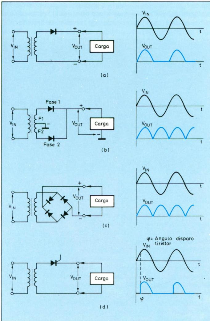
Figura 37. Estructuras electrónicas básicas y señales de entrada y salida de rectificadores: a) monofásico de media onda; b) bifásico de media onda; c) monofásico de onda completa; d) monofásico controlado de media onda.
