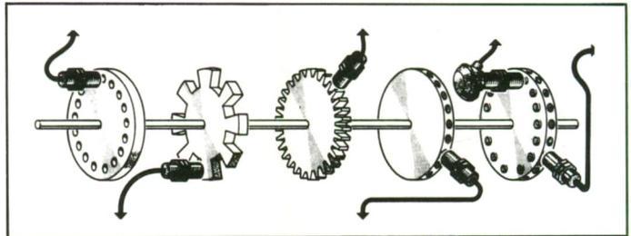
No obstante estos procedimientos presentan la necesidad de adaptar anteriormente el sistema rotativo, ya sea aplicando uno o varios salientes de material ferromagnético para activar el captador de impulsos inductivo, o bien con una
