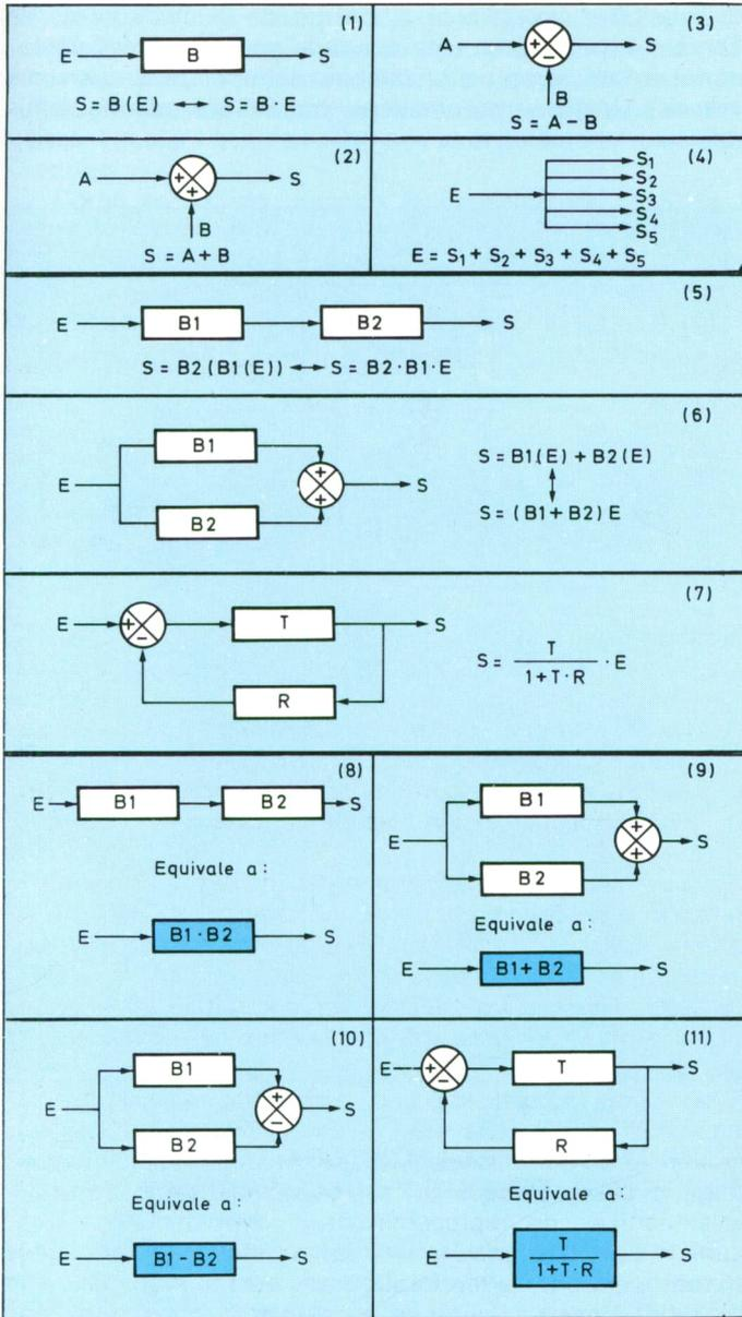
Figura 9. Diagramas estructurados de distintos servosistemas:
