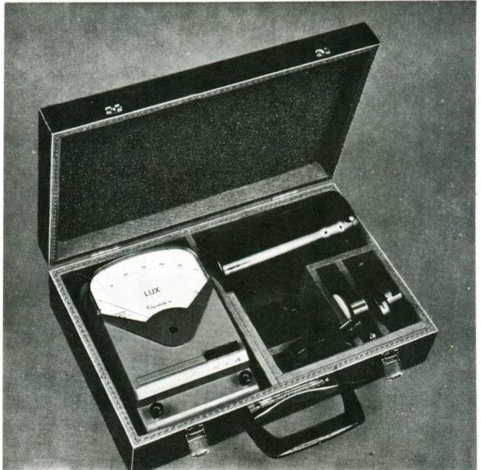
*Figura 29. Luxómetro portátil analógico con distintos accesorios ópticos de concentración y dispersión de luz.*
