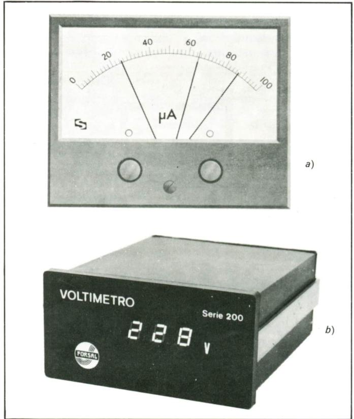
a) Microamperímetro analógico con escala de  $90^\circ$  y relés galvanométricos de máxima y mínima;
