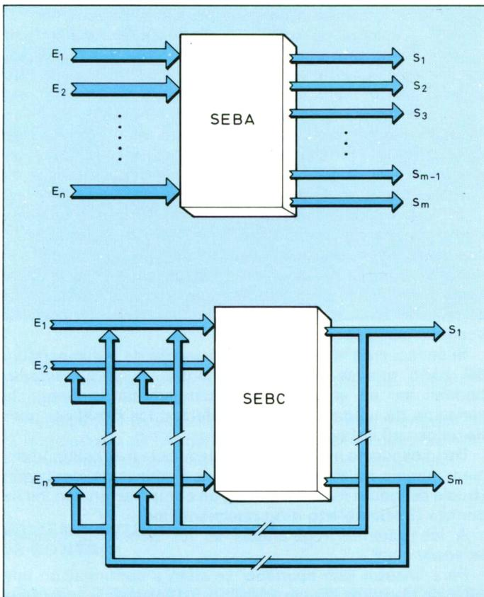
Figura 6. Diagrama de bloques de sistemas electrónicos de bucle abierto (SEBA) y de bucle cerrado (SEBC).
