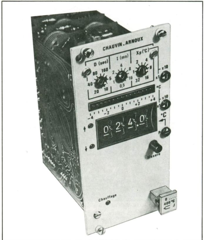
*Figura 5. Los reguladores electrónicos de temperatura son, actualmente, aparatos sofisticados pero muy versátiles. Detalle de un regulador electrónico con preselección digital.*
