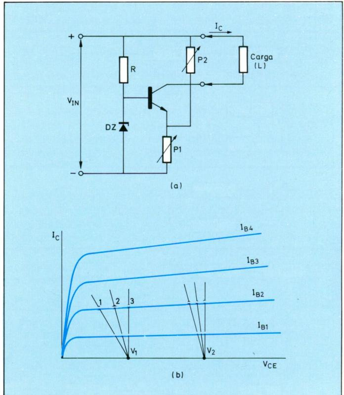
Figura 10. a) Esquema básico de un regulador de corriente; b) Curva característica del transistor del esquema anterior  $I_C = f(V_{CE})$  con diferentes rectas de carga y tensiones de alimentación.
