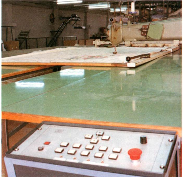
*Sistema de control totalmente automático de una mesa X-Y utilizada para seguir dibujos de libre diseño, de aplicación en confección industrial. (Cortesía: Spin, S.A.).*
