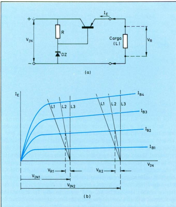
Figura 11. a) Esquema básico de un regulador de corriente; b) Curva característica del transistor del esquema anterior  $I_E = f(V_{IN})$  con diferentes rectas de carga. Nótese que  $V_{IN}$  se refiere a la tensión de alimentación de entrada.
