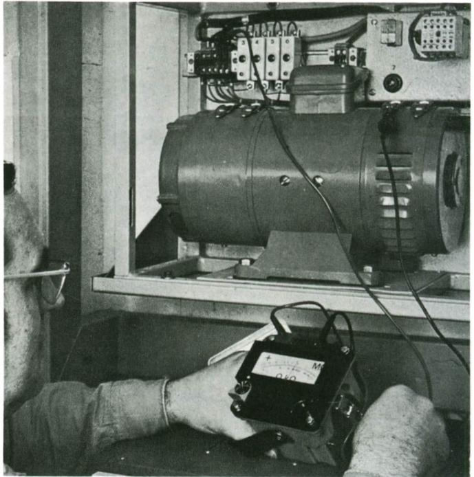
*Figura 24. Medida del aislamiento eléctrico entre dos puntos mediante un megóhmetro. Con este instrumento se pueden medir valores óhmicos muy elevados.*
