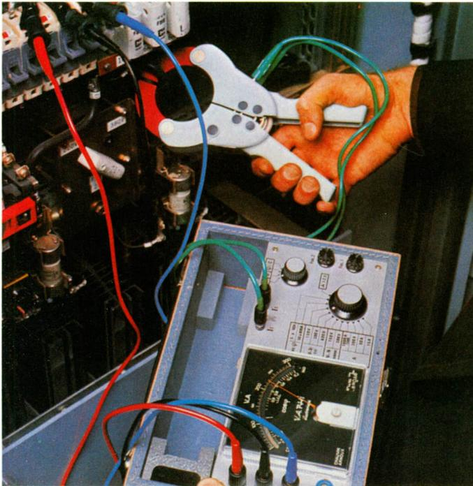
*Figura 22. Medidor portátil del factor de potencia con pinza. Resulta muy útil en la localización de averías en instalaciones que trabajan con tensiones elevadas.*
