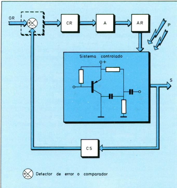
Figura 8. Diagrama de bloques de un servosistema; GR = generador de referencia; CR = corrector; A = amplificador; AR = actuador, y CS = captador.
