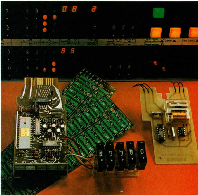
*Los circuitos integrados forman parte de los controles electrónicos para aplicaciones industriales. Detalle de un contador digital, con preselección, de cinco décadas (dígitos) y relé de excitación del elemento de maniobra.*
