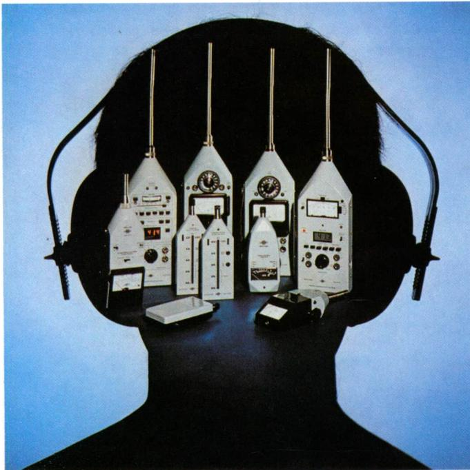
*Distintos tipos de sonómetros de precisión para medir niveles de ruido.
