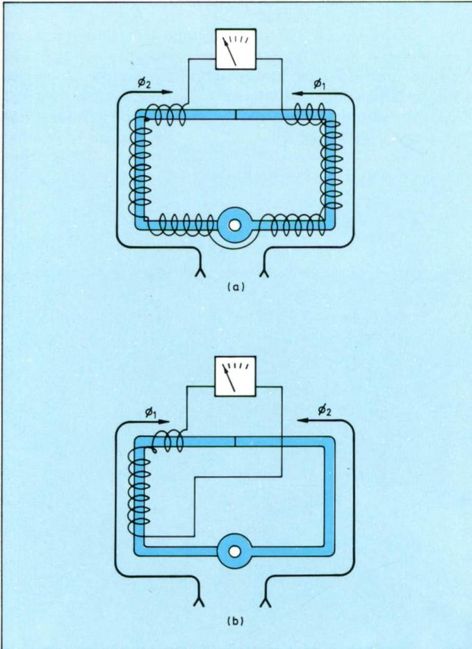
Figura 20. a) Pinza galvanométrica de bobinado completo; y b) de bobinado repartido.
