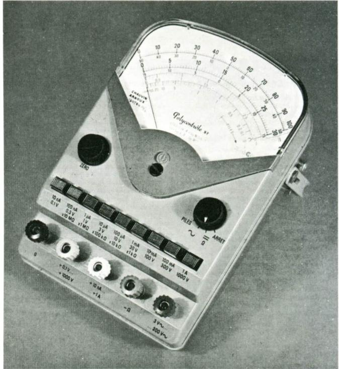
*Polímetro analógico portátil para uso industrial. La selección de las diferentes escalas se efectúa mediante una botonera.*
