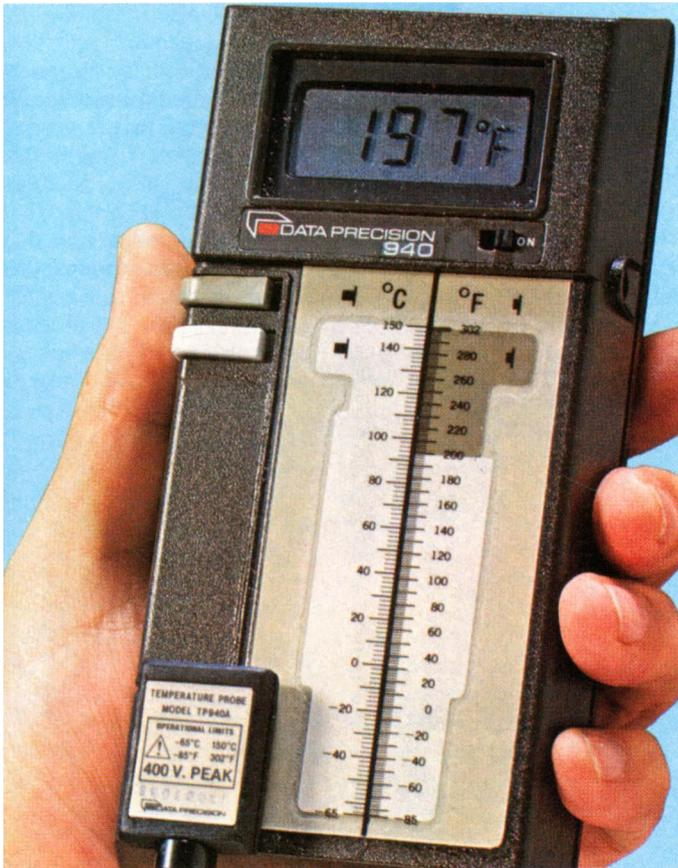
*Termómetro digital capaz de efectuar medidas de temperatura en grados centígrados y Fahrenheit. Es de tipo portátil y puede alimentarse con una fuente de alimentación auxiliar (pilas y/o baterías).*
