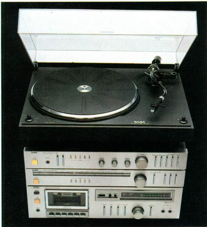
*El receptor de radio suele quedar dispuesto entre el amplificador y el reproductor de cassettes. La señal de salida del receptor se lleva al amplificador de potencia por la parte posterior del equipo.*
