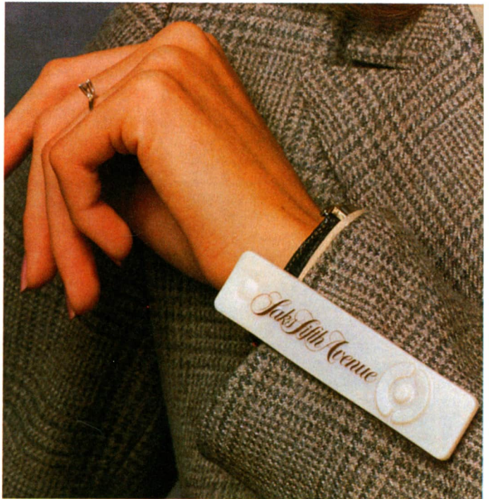
Figura 52. Etiqueta antirrobo adosada a una prenda de vestir y que resulta muy práctica en grandes almacenes. Sólo puede extraerse en el momento de pagar mediante un desactivador especial que existe en las cajas.
