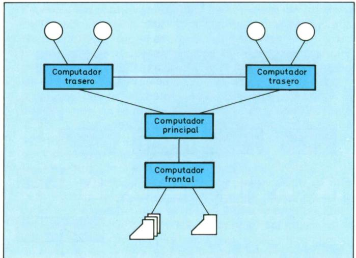
*Figura 6. Estructura de computador apoyada en computadores auxiliares para manejar periféricos de almacenamiento masivo de información.*
