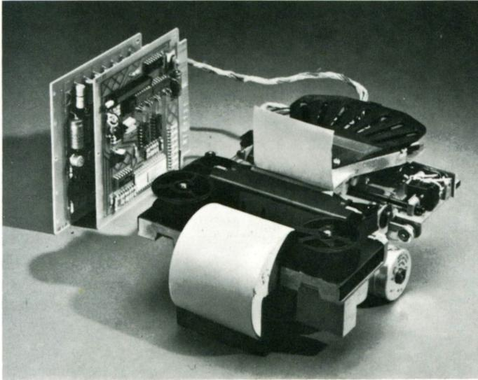
*Mecanismo de una impresora de agujas. En un reducido espacio se acumulan componentes mecánicos y electrónicos de alta precisión y elevada fiabilidad.*
