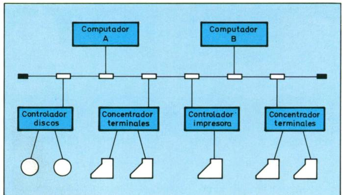
*Figura 9. Estructura de un sistema informático basado en una red de ámbito local.*
