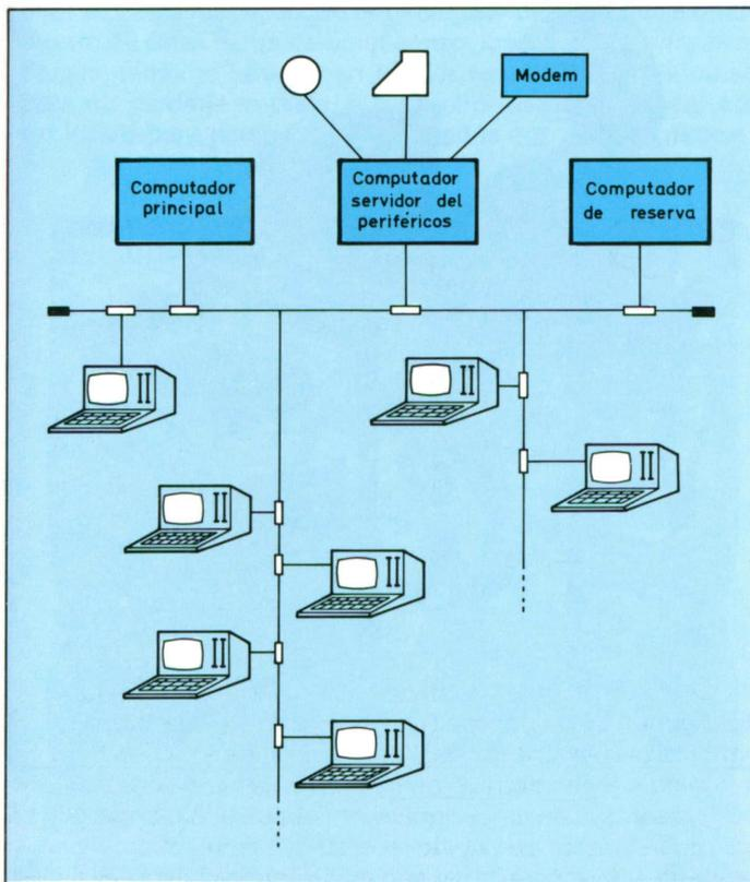
*Figura 12. Instalación de una oficina automatizada en la que computadores personales/profesionales actúan de terminales inteligentes de un computador mayor, conectados a éste a través de una red local, para optimizar así los costes de la conexión.*
