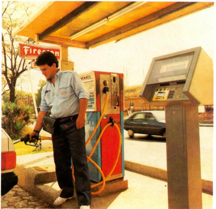
*Uno de los primeros terminales NCR instalados en nuestro país para el pago de carburante mediante tarjetas de banda magnética. Gracias a la tarjeta puede seleccionarse el surtidor a emplear, el tipo de carburante y el importe o los litros deseados.*
