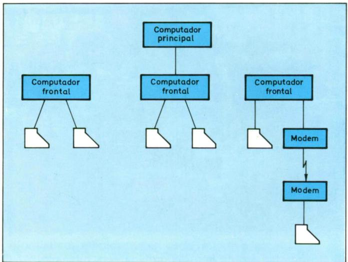
Figura 3. Estructura de un sistema informático jerárquico basado en un computador personal.
