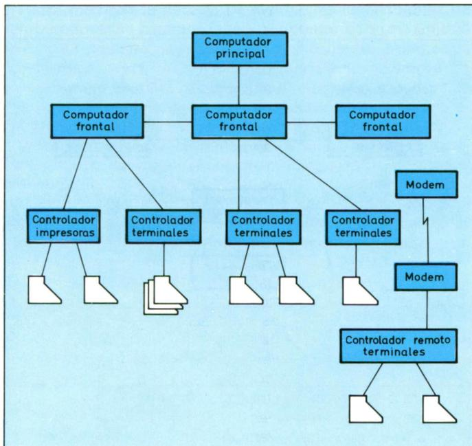
Figura 5. Estructura de un sistema informático jerárquico con varios niveles de proceso.
