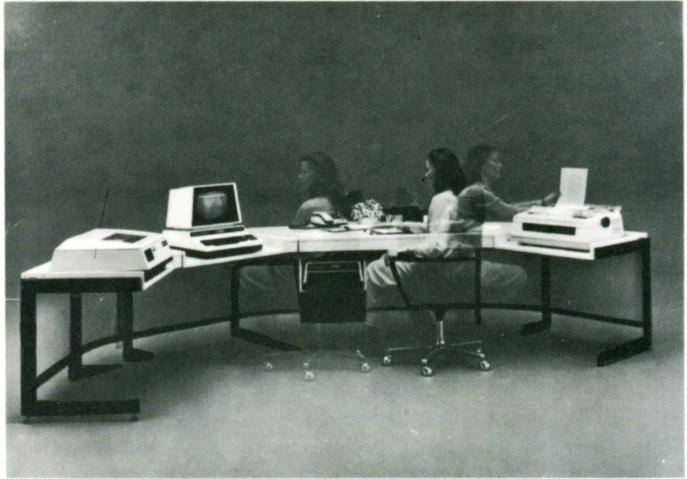
*Figura 18. Puesto de edición e impresión de textos en el que coexisten una impresora rápida (aguja), a la izquierda, y una de calidad (margarita), a la derecha.*
