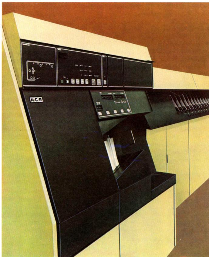
*Lectoclasificadora de alto rendimiento para documentos con caracteres magnéticos (MICR). Las cámaras de compensación bancaria y cajas de ahorro las utilizan.*
