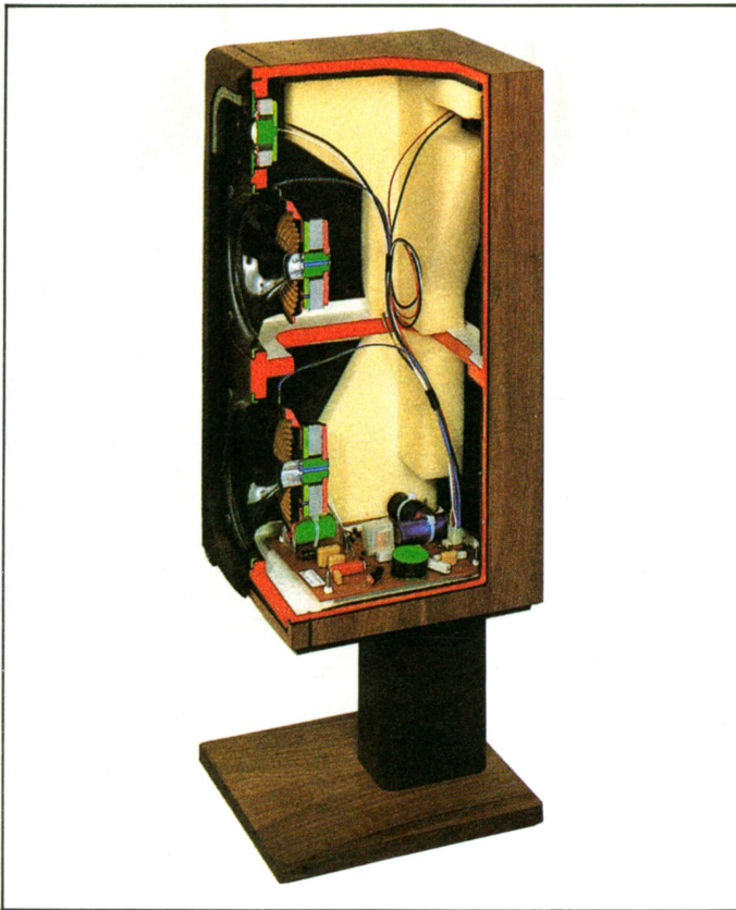
Vista en sección de un baffle en donde se observa el circuito de filtro que separa las tres bandas de frecuencias: agudos, medios y graves. También puede verse el material absorbente para el sonido procedente de la parte posterior de los conos.
