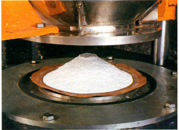
Membrana de altavoz antes de ser prensada y en su fase de elaboración.
