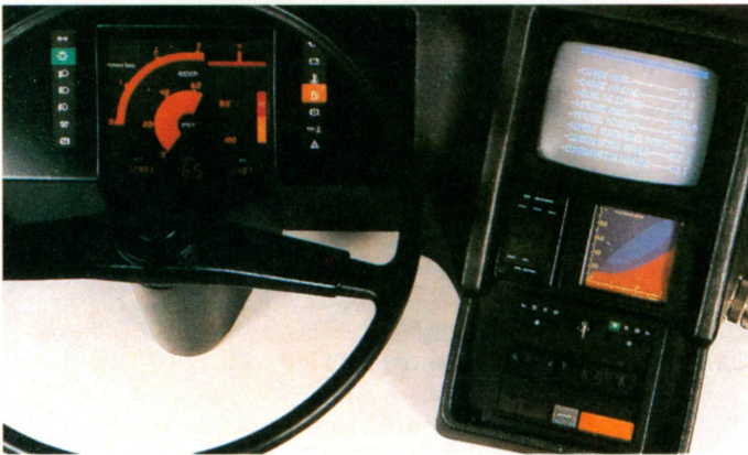
En la parte superior se observa el tablero de a bordo con display de cristales líquidos y un sintetizador de palabra. En la parte inferior se ve el tablero de a bordo EVE con pantalla de tubo de rayos catódicos de chequeo del vehículo. Se trata de uno de los sistemas más sofisticados de los que se fabrican en la actualidad (Cortesía: Jaeger).
