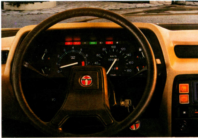
Panel de mandos de un Talbot con indicadores de nivel de aceite, contenido de combustible, luces, etc., para controlar el comportamiento del coche en funcionamiento.
