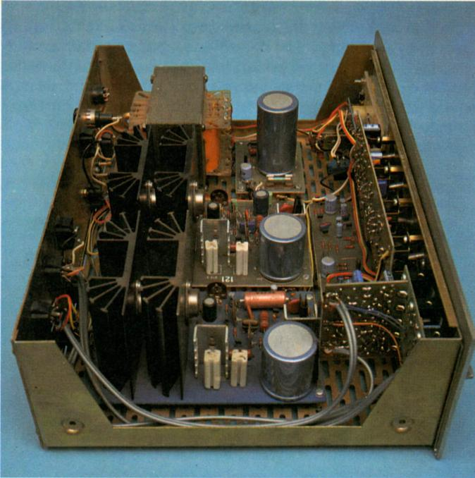
*Vista interna de un amplificador estereofónico después de quitar la tapa superior, en él destacan el transformador de red, los radiadores de los transistores finales y los electrolíticos de alimentación y de las etapas de salida.*
