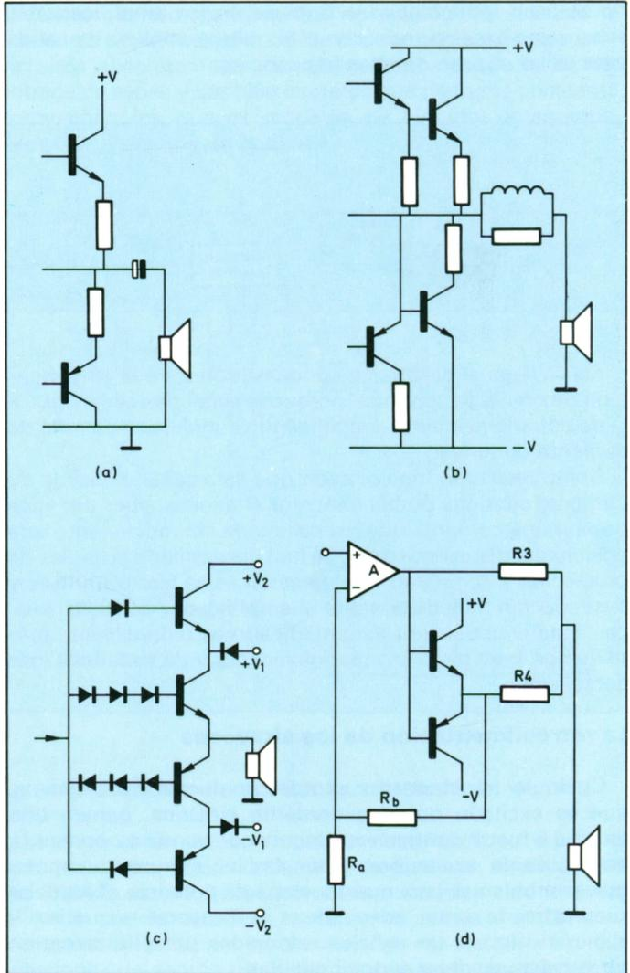
Cuatro etapas de salida simplificadas. a) Etapa clase B clásica mediante condensadores; b) Etapa casi-complementaria; permite usar dos transistores de igual potencia; c) Etapa clase C. Una aproximación a la mejora del rendimiento, permitiendo altos picos de potencia y reducido consumo en reposo o baja señal. d) Etapa «current dumping» o volcado de corriente. Corrige las no-linealidades de los transistores de salida reduciendo la distorsión de forma total.
