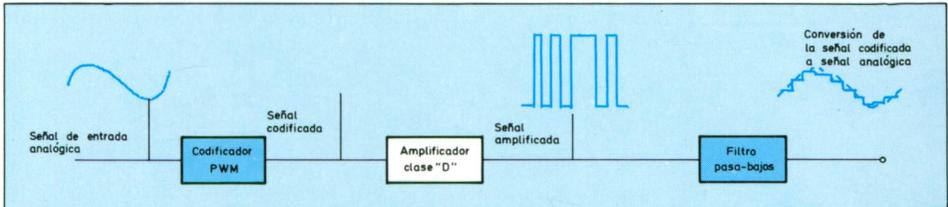
Así se llega al diseño sin condensadores y a la amplificación de corriente continua, porque la señal de salida sigue a la de entrada fielmente, amplificándola incluso si se trata de corriente continua.
