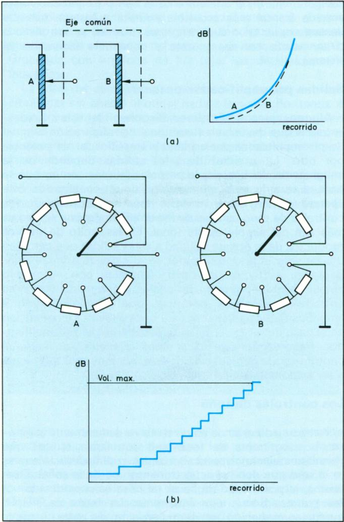
*Construcción de potenciómetros en sustrato cerámico o plástico. a) Con 22 elementos de resistencia la distancia entre saltos es menor y se aproxima al potenciómetro de carbón; b) Con 11 elementos de resistencia su uso es más adecuado para controles de tono.*
