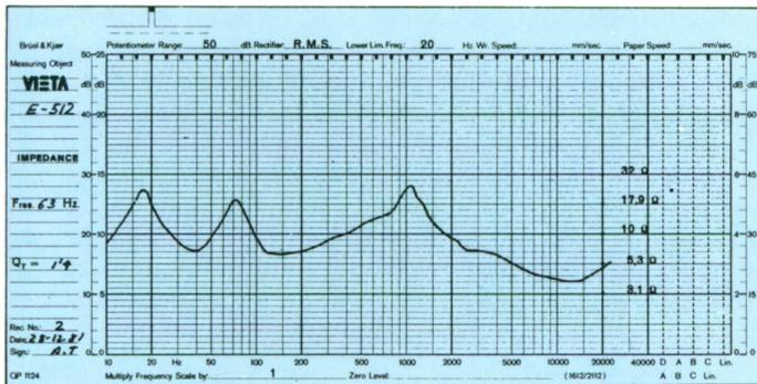
*Variación del módulo de la impedancia en una caja acústica de calidad media-alta. Además de variar el módulo de la impedancia también varía con la frecuencia el ángulo de fase  $\phi$ .*
