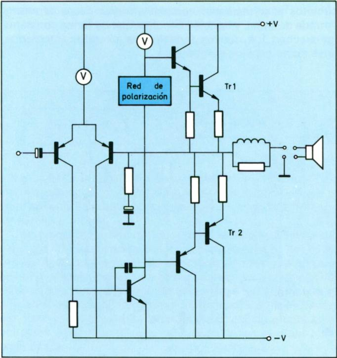
*Esquema simplificado de una etapa de salida en clase B, complementaria, con alimentación partida y sin condensador de salida. Esta configuración con más o menos variaciones ha sido profusamente utilizada en amplificadores comerciales. Tr1 y Tr2 forman la pareja de transistores complementarios.*
