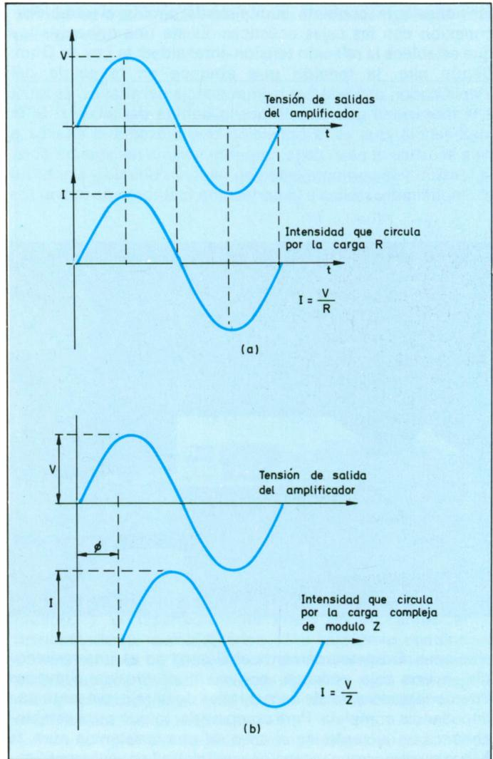
Problemas de las cargas complejas. a) Las curvas de tensión y corriente están en fase y el amplificador controla perfectamente la potencia suministrada a la carga resistiva pura R; b) La intensidad circulante está desfasada respecto a la tensión, siendo  $\phi$  este desfase que varía según la frecuencia. La amplitud  $I$  depende de la tensión  $V$  y del módulo de la impedancia compleja  $Z$ .
