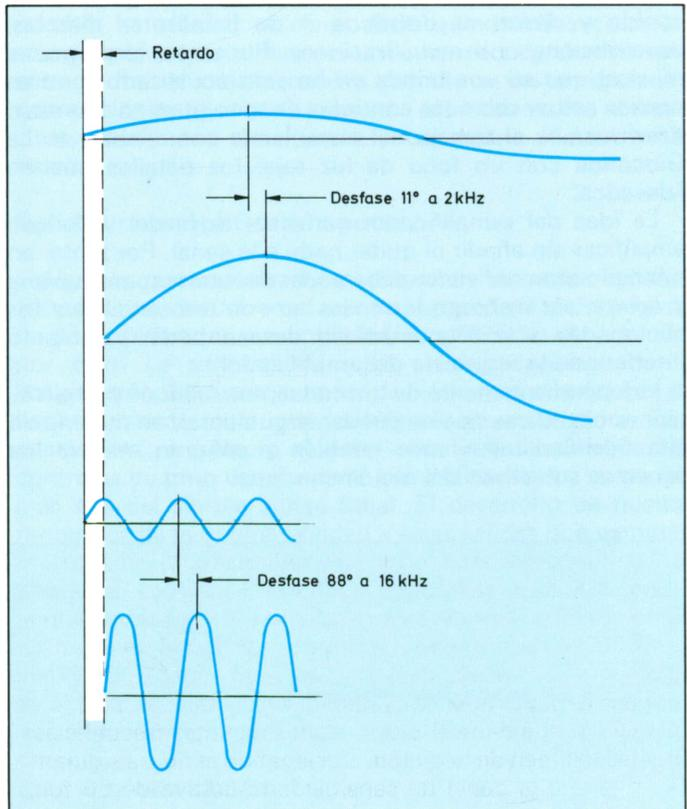
*Distorsión de fase o retardo de señal. Sus efectos en señales de baja frecuencia son despreciables. En señales de alta frecuencia el retardo tiene valor significativo con respecto al período de la señal.*
