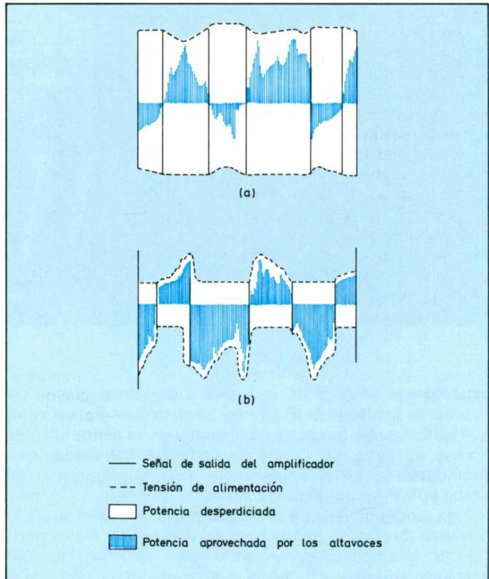
*Funcionamiento de un amplificador con fuente de alimentación variable. La potencia desperdiciada se reduce y, por tanto, el tamaño del aparato; en cambio la circuitería es más sofisticada.*
