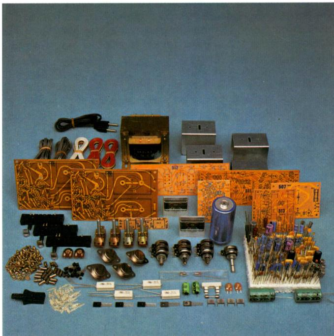
*Los componentes que intervienen en el montaje del amplificador estereofónico son numerosos, especialmente si el circuito sigue la técnica modular a base de transistores.*
