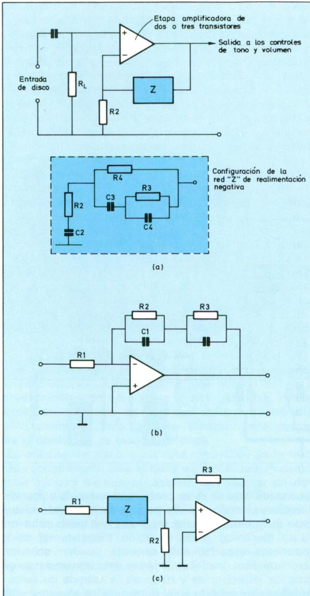
Esquemas básicos de distintos preamplificadores de entrada de cápsula magnética con ecualización RIAA. Obsérvense las diferentes soluciones a un mismo problema. a) Esquema convencional; la red «Z» de realimentación contiene la configuración para la curva RIAA; b) Esquema paralelo o «shunt»; c) Red pasiva seguida de un amplificador lineal.
