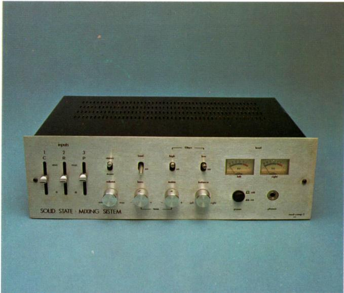
*Amplificador estereofónico de 25 W por canal que se puede adquirir en el mercado en forma de kit. Se observan en la carátula frontal los mandos, los controles y los indicadores de sintonía.*
