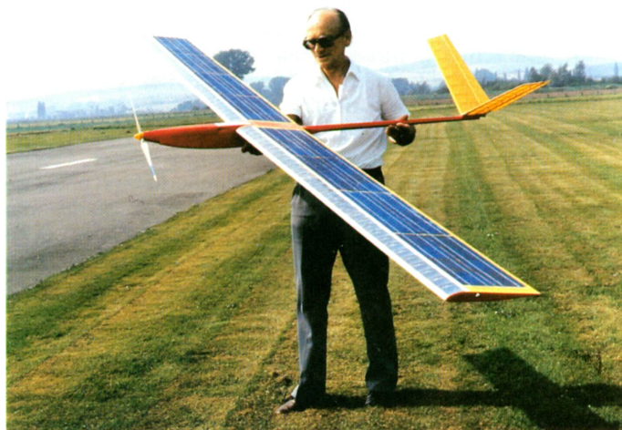
También la energía solar fotovoltaica tiene aplicación en el aeromodelismo. Las células solares se encargan de alimentar toda la circuitería electrónica de este bellissimo planeador. (Cortesía: Telefunken).
