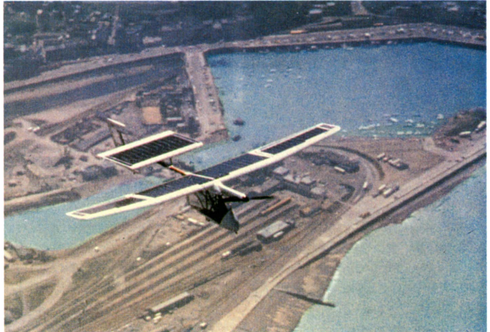
El avión Challenger cruzó el Canal de la Mancha en un vuelo experimental. Las partes azuladas en las alas son los paneles de células solares. (Cortesía: DuPont).
