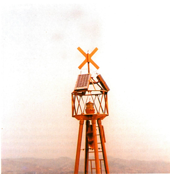
Paneles que forman parte de una instalación para una boya de señalización marina (Cortesía: Isofotón).
