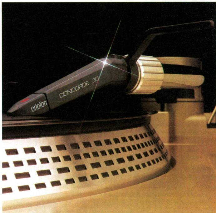
*Cantilever de baja masa, modelo Concorde 30 de Ortofon. El poco peso permite una mejor adaptabilidad a las características del surco sin que ello suponga una presión excesiva sobre la aguja que podría dar lugar a una deformación de ésta.*
