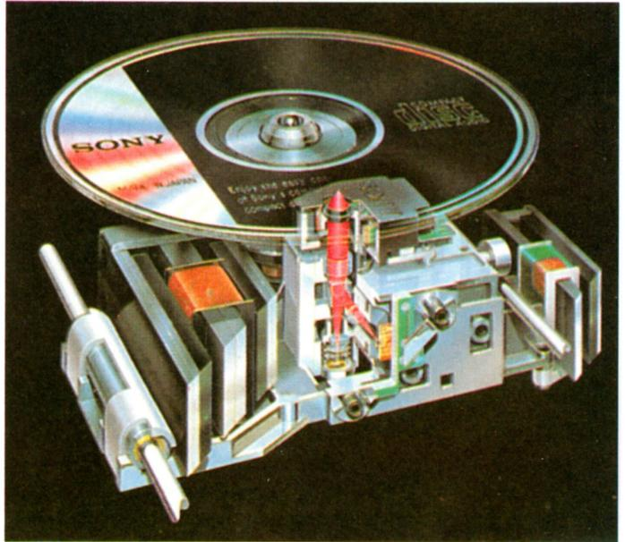
*Reproductor para «compact-disc» que incorpora un motor lineal para seguimiento del tracking y para alta velocidad, con posibilidad de acceder a cualquier punto del disco casi de forma instantánea. (Cortesía: Sony).*
