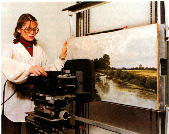
La tecnología empieza a ser utilizada también para proteger las obras de arte, patrimonio de la Humanidad. En la fotografía puede verse un espectrofotómetro de reflectancia que mide las variaciones graduales de color de los cuadros, debido entre otros factores a la luz, contaminación, humedad y temperatura. (Cortesía: National Gallery, Londres).
