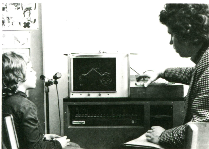
Una firma inglesa ha desarrollado un equipo electrónico que permite ayudar a los sordomudos a ejercitar el habla, basándose en fonemas previamente registrados y almacenados en la memoria del equipo.
