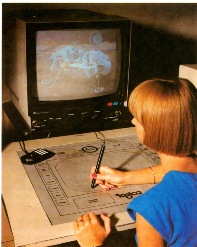
Moderna forma de dibujar y pintar empleando un computador. El «lápiz electrónico» sitúa sobre una pantalla las zonas coloreadas.
