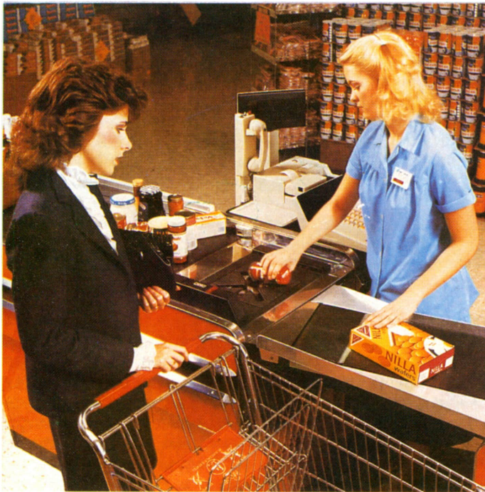
Sistemas NCR lectores de códigos de barras para los pasillos de salida de las cajas de los supermercados. Se trata de una poderosa ayuda, que alivia el trabajo de la dependienta y se controla en todo momento el nivel de stocks de los diferentes productos.
