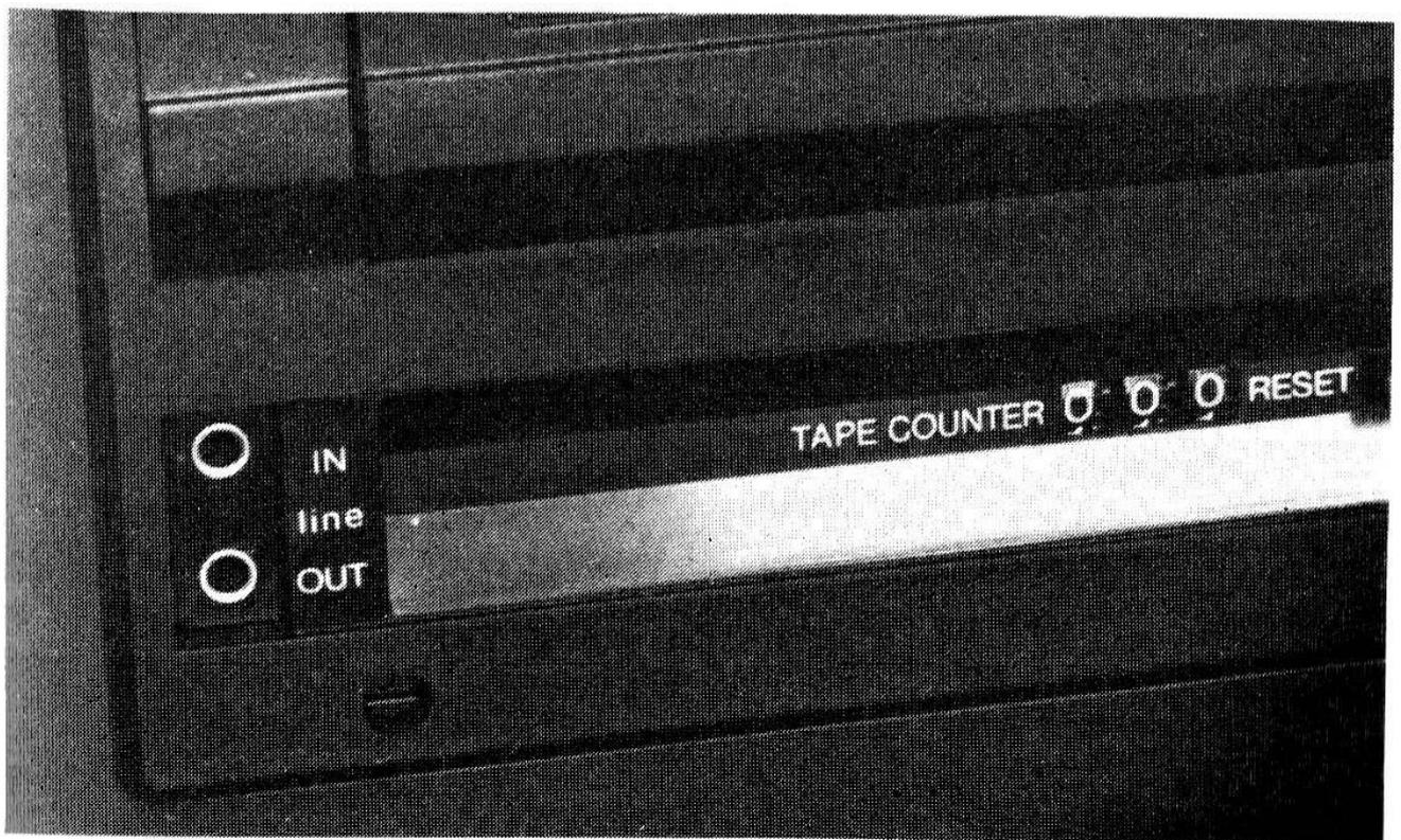
*L'utilisation de prises « ligne » exige le recours à un accessoire amplificateur. Noter la présence d'un compteur de bande, très commode à l'usage.*
