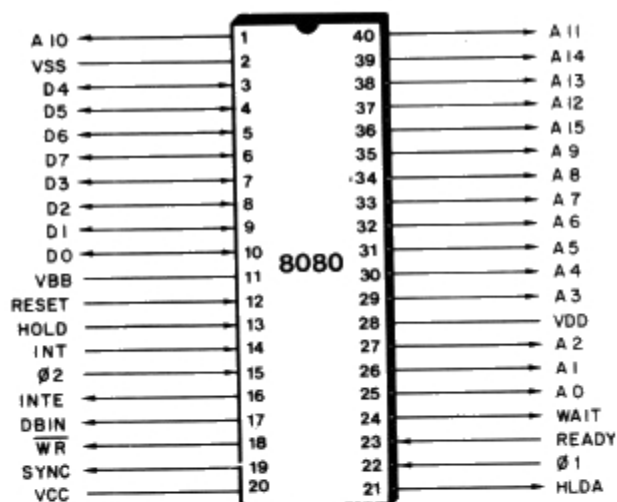
Fig. VI.1 Configuração dos pinos.
