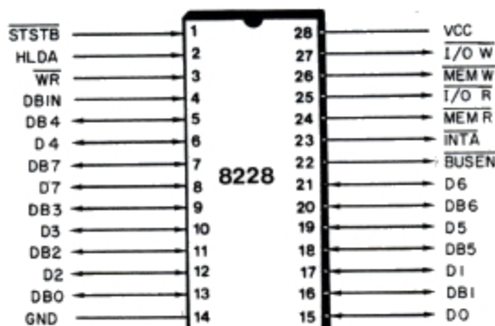
Fig. VIII.1 Configuração dos pinos.
