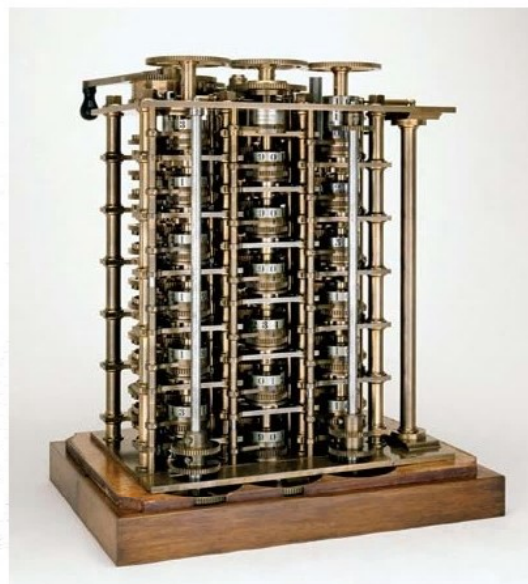
Fig. 1.3 – A Máquina de Babbage de 1822
