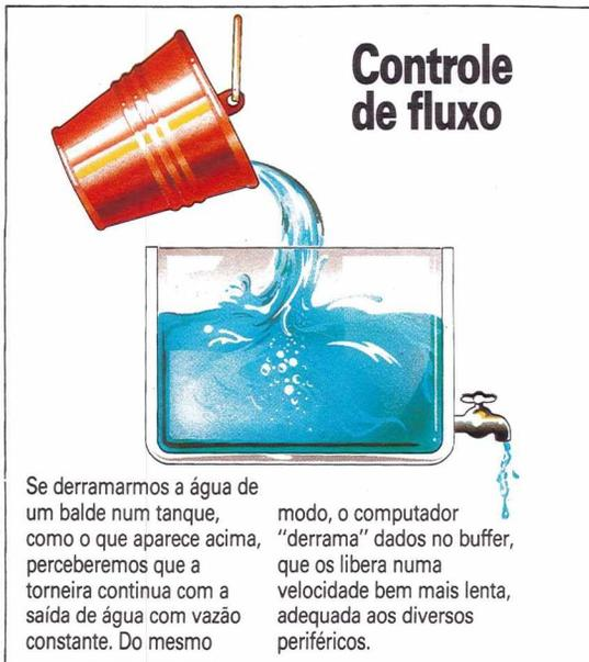
Se derrarmos a água de um balde num tanque, como o que aparece acima, perceberemos que a torneira continua com a saída de água com vazão constante. Do mesmo modo, o computador "derrama" dados no buffer, que os libera numa velocidade bem mais lenta, adequada aos diversos periféricos.
