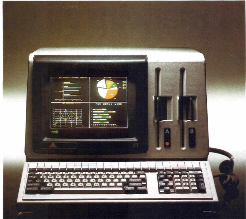
do teclado e o controle da tela. Um método para isso é “interromper-acionar”, em que um circuito eletrônico especial interrompe o microprocessador praticamente cinquenta vezes por segundo e “lembrar” de desempenhar suas tarefas de manutenção e outras funções relativas à tela e ao teclado, antes de retomar o que estava fazendo.
