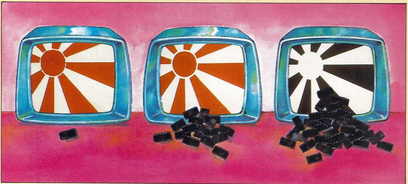
Nos gráficos em bloco de baixa resolução, pouca capacidade de memória, como 1 Kbyte, é suficiente para armazenar todos os detalhes do que deve aparecer na tela. Se houver apenas quarenta blocos em cada linha e só 24 linhas na tela, o número total de blocos será de 960, quase 1 kilobyte. Assim, 1 kilobyte de memória para a tela pode armazenar até 8 bits de dados para cada bloco na tela.
