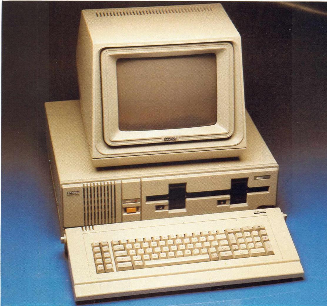
As características ergonômicas do Nexus 1600, desenvolvidas pela Scopus, permitem uma melhor adaptação do operador à máquina. O vídeo basculante com tela anti-reflexo, o teclado leve e de inclinação variável, o cabo espiralado que liga o teclado à unidade de sistema são importantes requisitos que visam sobretudo o conforto e produtividade do usuário.
